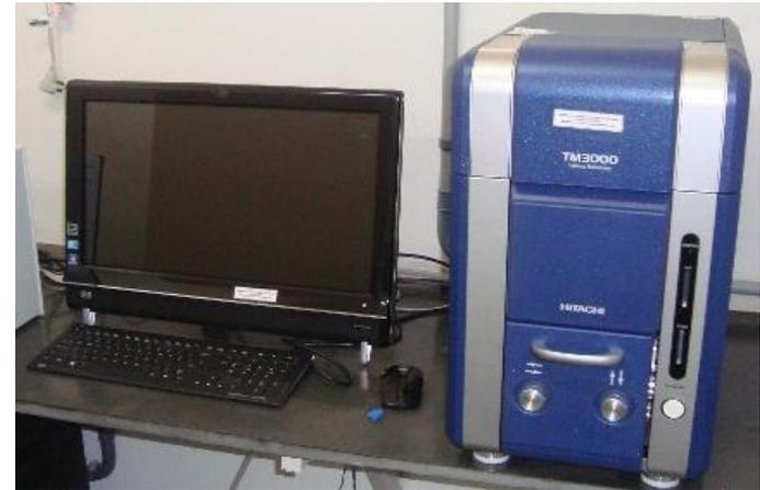
Foi utilizando um microscópio eletrônico de varredura modelo Hitachi –TM -3000 do laboratório da UniFOA operado com uma tensão de 15KV de aceleração.
