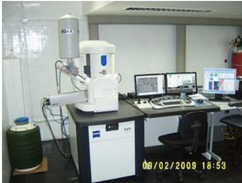
Foi utilizado o EDS do Laboratório da UFF (Universidade Federal Fluminense) modelo EVO MA10 da Zeiss.
