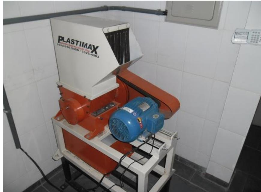
Moinho granulador do fabricante Plastimax no Laboratório de Ensaios Mecânicos do Centro Universitário de Volta Redonda UniFOA para redução da granulometria
