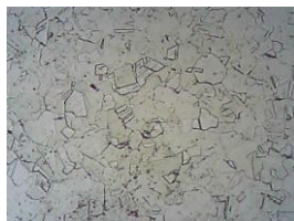
Figura 7 – Micrografia do aço inoxidável 304 obtida com o microscópio ótico, com ampliação de 400 vezes; b) MEV com ampliação de 3000 vezes
