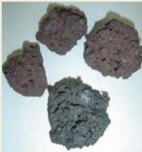
Aglomerado com adequação de granulometria para aplicação em usinas siderúrgicas após o processo de sinterização.
