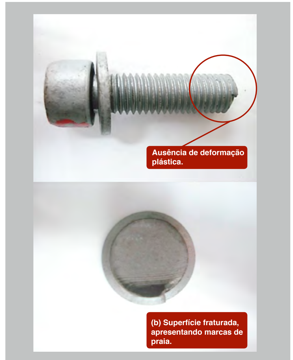
Figura 42: Parafuso de fixação do suporte elástico do motor. (a) ausência de deformação plástica. (b) marcas de praia na superfície fraturada. Fonte: Autora (2013).
