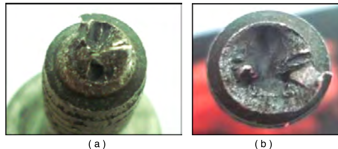
Figura 36: (a) e (b) - Fotomacrografias das superfícies de fratura. Fonte: Autora (2010).
