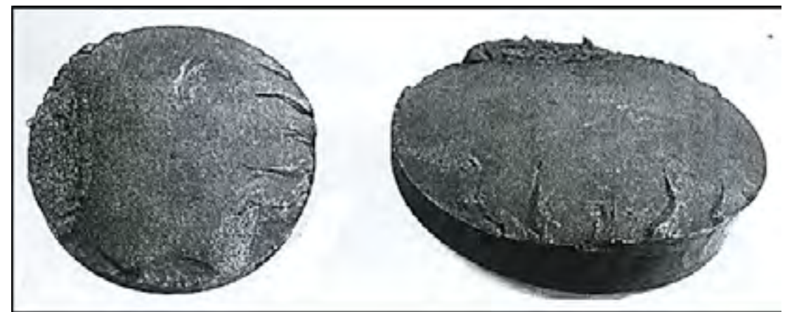
Figura 28: Fratura de um eixo com aspecto característico de marcas de catraca [GODEFROID; CÂNDIDO, 2011].
