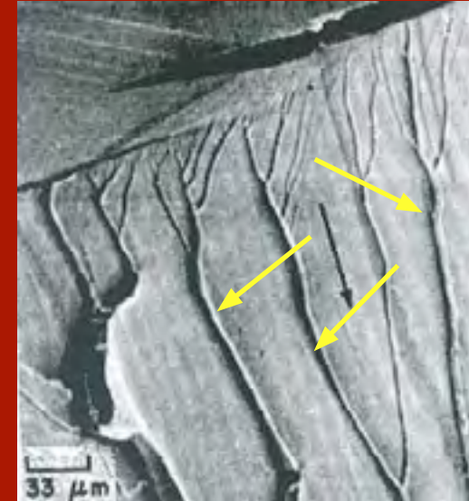
Figura 14: Marcas de rio em superfícies de fratura frágil de um material em ferro puro com matriz ferrítica [GODEFROID, CÂNDIDO, 2011].
