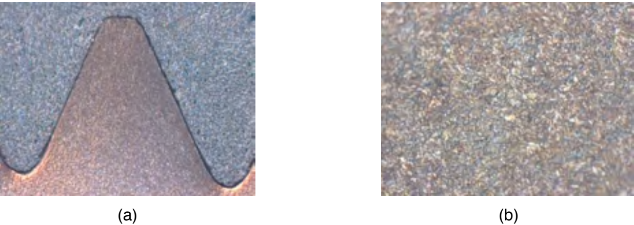
Figura 46: Fotomicrografias do parafuso. (a) observa-se ausência de descarbonetação na superfície dos filetes do parafuso. (b) microestrutruura da região central do parafuso, formada por cerca de 90% de martensita.
