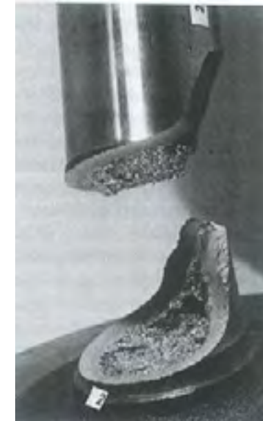
Figura 12: Macrofractografia de um aço SAE 1050 com fratura frágil [GODEFROID, CÂNDIDO, 2011].
