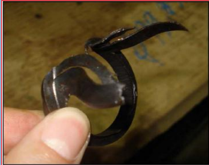
Anel guia danificado
