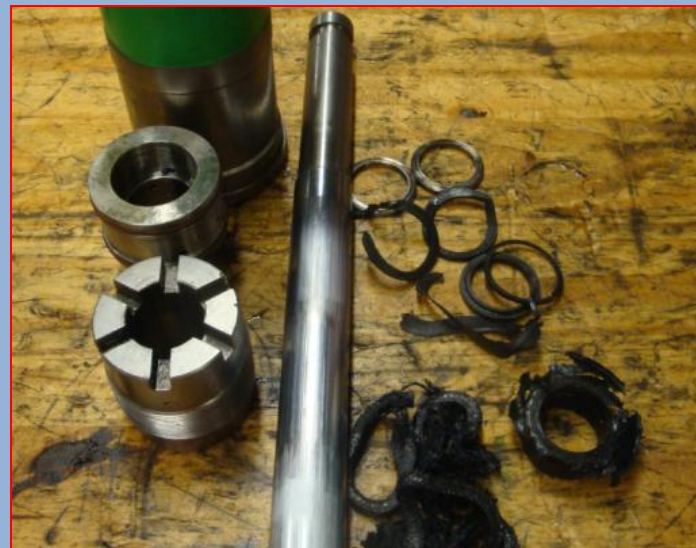
Anéis e gaxetas deformadas
