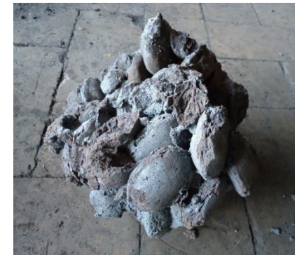
Formação de cachos em tecnologias de redução e fusão
