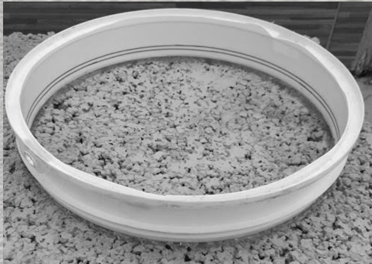
Figura 32: Montagem do ensaio para determinação do coeficiente de permeabilidade (a) Fonte: Autor, 2018.
