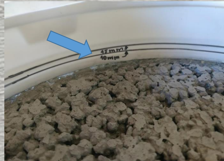
Figura 33: Montagem do ensaio para determinação do coeficiente de permeabilidade (b) Fonte: Autor, 2018.
