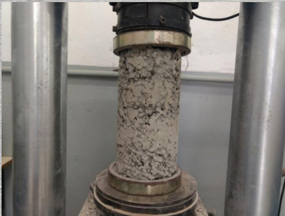
Figura 21: Rompimento dos CP's na EMIC PC150C
