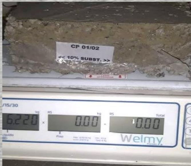
Figura 25: Pesagem do CP saturado por 72h Fonte: Autor, 2018.
