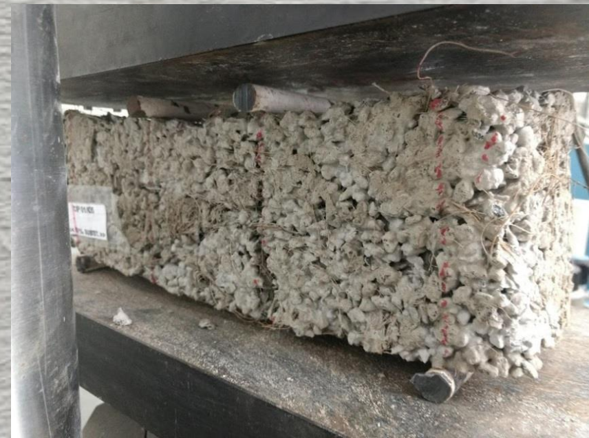
Figura 30: CP rompido na prensa após realização do ensaio de tração à flexão
