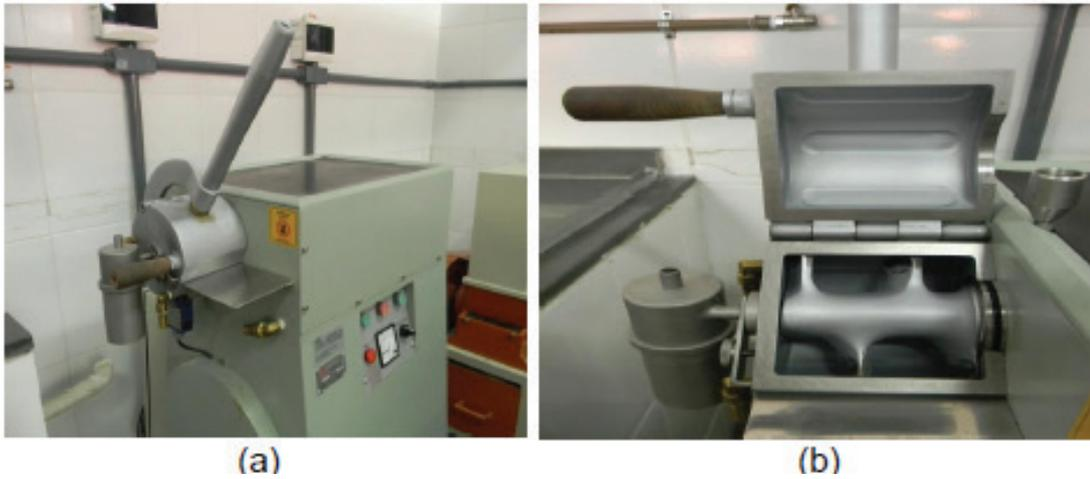
Figura 3. Homogeneizador (a) e detalhe da cápsula de mistura (b).
