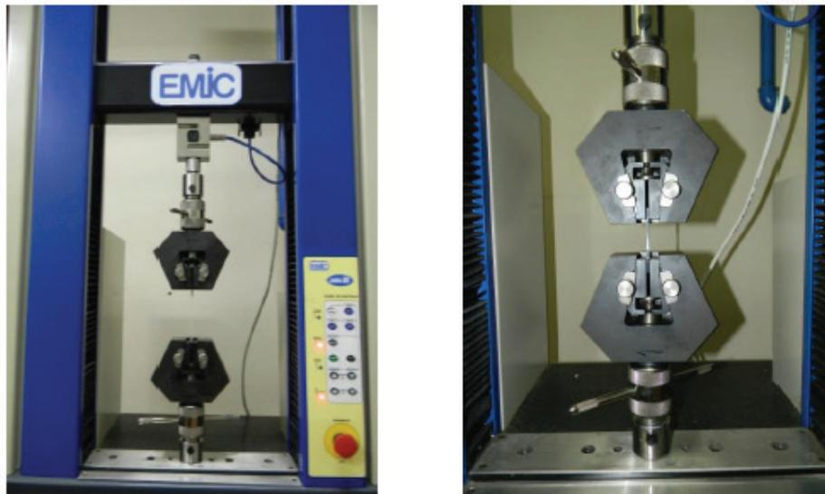
Figura 6. Máquina de ensaio mecânico EMIC.
