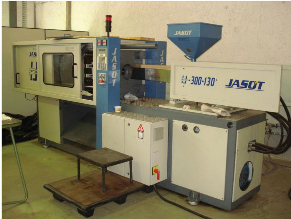
Figura 5. Máquina Injetora
