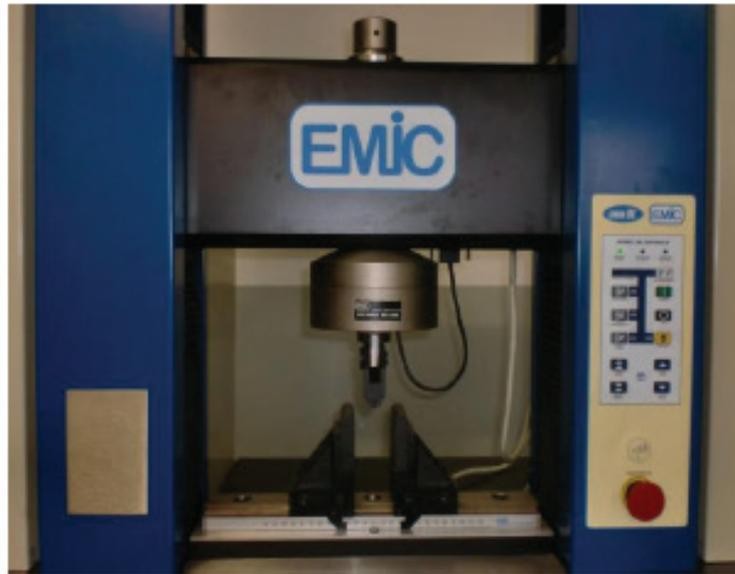
Figura 8. Dispositivo usado para o ensaio de flexão.
