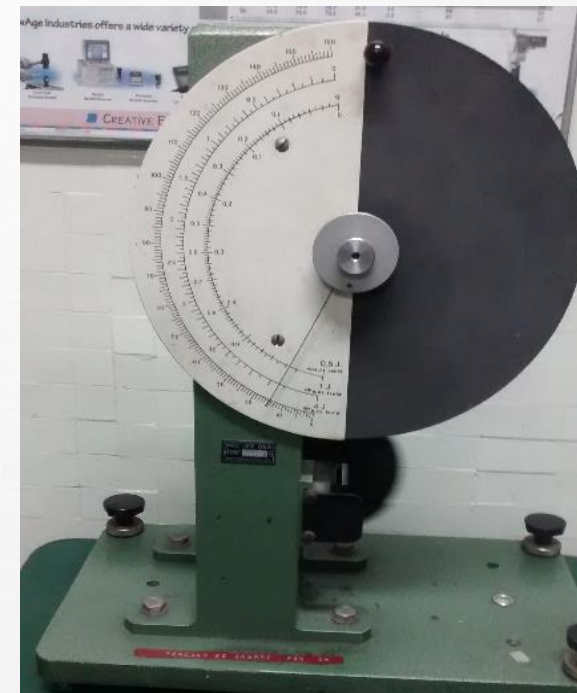
Máquina Wolfgang Ohst Rathenow impacto tipo Charpy FONTE: o Autor, 2016
