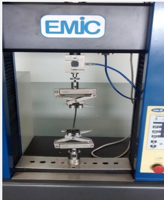
Máquina universal EMIC 1000 ensaio de tração FONTE: o Autor, 2016
