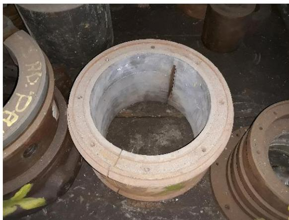
*Figura 2 - Mancais limpos, após a retirada do metal patente, prontos para enchimento.*
