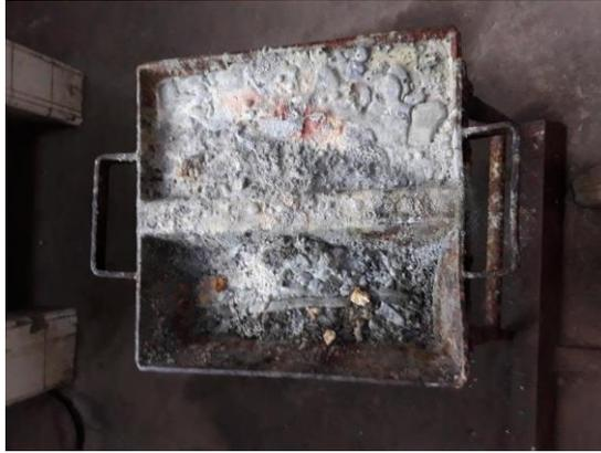
*Figura 3 - Recipiente de depósito do metal patente para descarte, com acúmulo de impurezas.*
