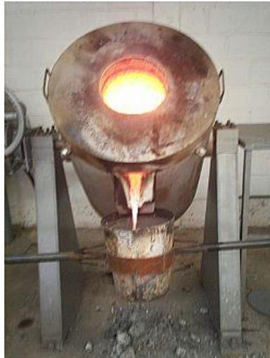
*Figura 4 - Exemplo de forno onde o vazamento não é pela borda superior.*
