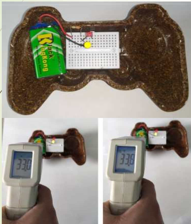
Figura 34 – Manete com bateria e medição da temperatura
