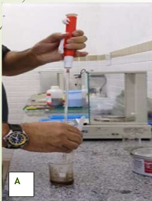
Figura 14 – A ) Adição do endurecedor a mistura resina/fibra. B) Conformação dos CP's nos moldes. C - Molde
