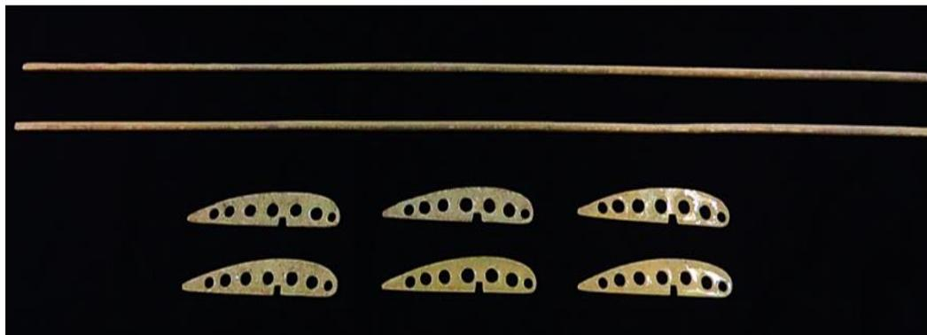
Nervuras e longarinas da asa feitas com fibras trituradas e resina epóxi já montada sobre a parte inferior da asa.
