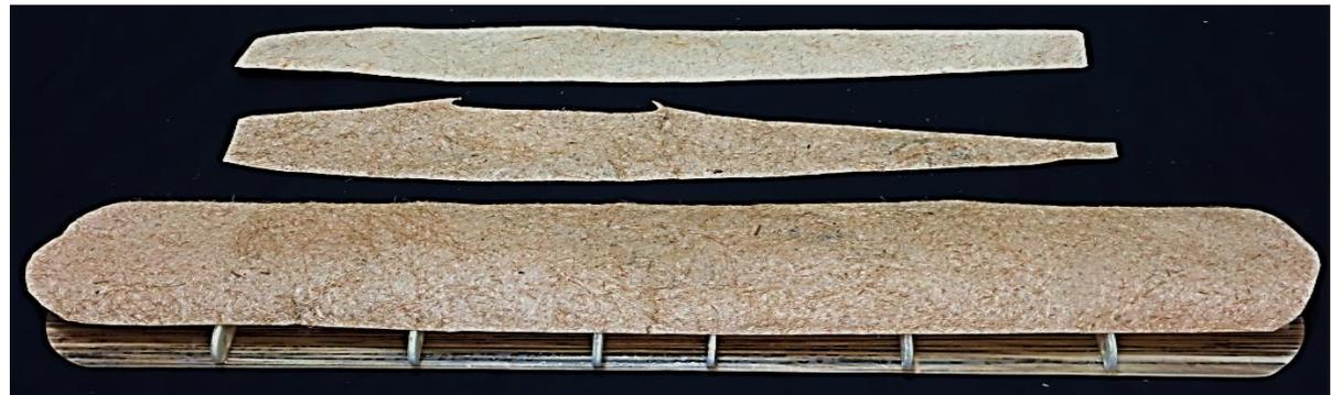
Para demonstrar que a asa do aeromodelo construído com fibra de bananeira e resina epóxi, cumpre as exigências definidas pelas normas [RBAC-E 94](#) (ANAC) e [AIC-N 17](#) (DECEA) sobre a resistência da asa para suportar as forças aerodinâmicas, aplicou-se uma carga de 4,050 kg, que corresponde a, praticamente, 10 vezes o peso do total do aeromodelo.
