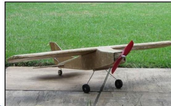
Para a parte inferior da asa e a parte inferior da fuselagem do aeromodelo usou-se o compósito com fibras longas e resina epóxi
