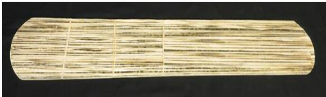
Para a fabricação das nervuras das asas e longarinas da fuselagem foi usado o compósito com fibras trituradas e resina epóxi.
