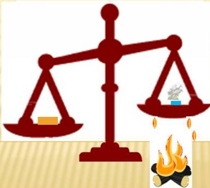
É a técnica na qual mede-se a mudança da massa em função da temperatura ou tempo, quando a amostra está submetida à uma programação controlada de temperatura.
