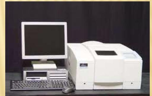
Esta análise baseia-se em bandas de frequências vibracionais de um átomo ou um conjunto de átomos de uma dada estrutura molecular que resulta da absorção da luz na faixa do infravermelho e que permite a caracterização de grupos funcionais ou até da substância
