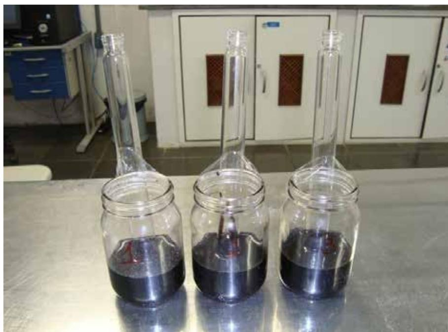
Figura 10. Fixação das amostras no recipiente para o ensaio de sorção.
