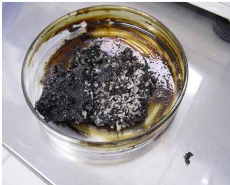
Figura 17. Falha de Sorção do Material.
