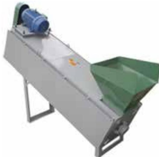
Figura 6. Lavadora e secadora.
