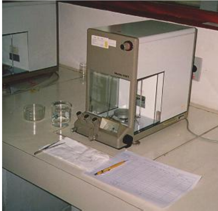
Figura 05 - Vista geral da balança analítica eletrônica utilizada na pesagem dos corpos-de-prova para determinação da massa específica aparente.
