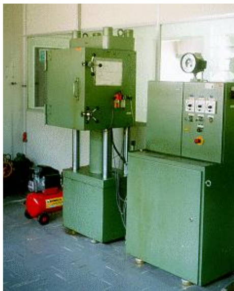
Figura 03 - Vista geral da prensa isostática KIP 100 E, marca Paul Weber. Observa-se a câmara de prensagem (à esquerda) e o painel de controle (à direita).
