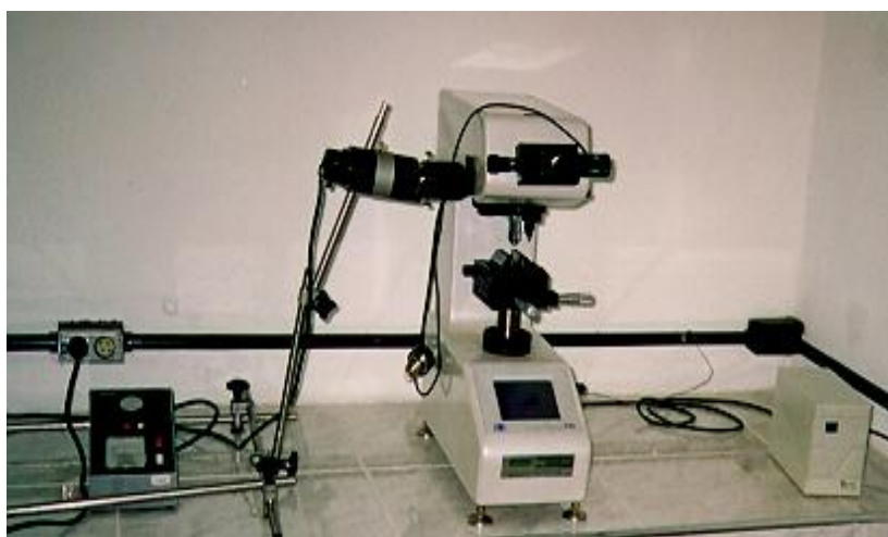
Figura 07 - Vista geral do equipamento utilizado para determinação de microdureza Vickers.
