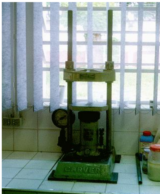
Figura 02 - Vista geral da prensa hidráulica uniaxial utilizada na compactação a frio.
