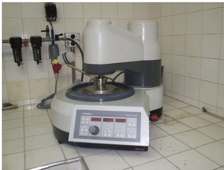
Figura 06 - Politriz automática utilizada na preparação dos corpos de prova.
