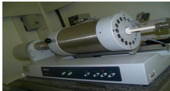
Figura 8 – Dilatômetro NETZSCH modelo DIL 402C
