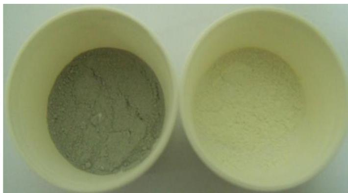
Figura 2 – Nanocargas de  $\text{Al}_2\text{Mo}_3\text{O}_{12}$  funcionalizadas e não funcionalizadas
