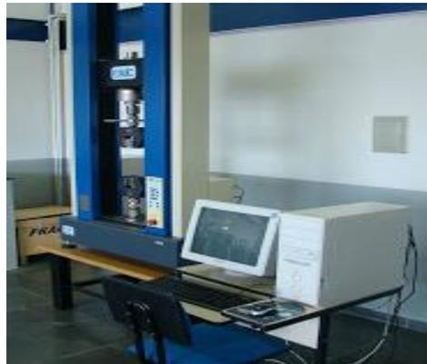
Figura 10 – Máquina Universal EMIC utilizada nos ensaios
