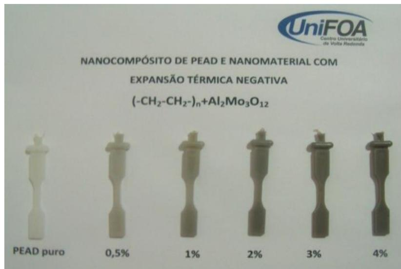
Figura 6 – Nanocompósito com o material  $Al_2Mo_3O_{12}$  não funcionalizado
