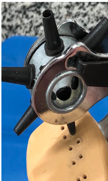
Figura 8 – Realização dos furos na posição desejada, para aplicação do cimento resinoso(Fonte: O Autor)
