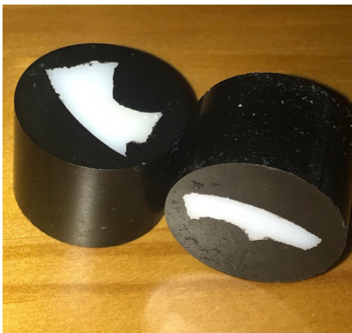
Figura 13 – Corpos de prova para o ensaio de microdureza Vickers Fonte: O Autor
