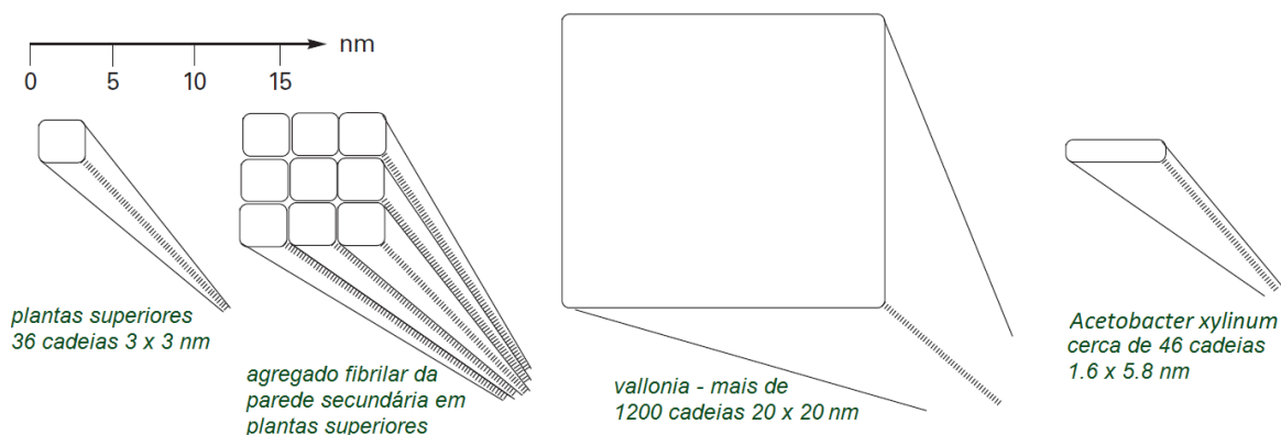
Figura 9. Formas sugeridas de fibrilas de celulose.
