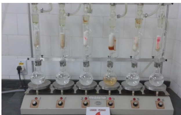
Figura 20. Extratores Soxhlet para remoção dos extraíveis da palha de cana.
