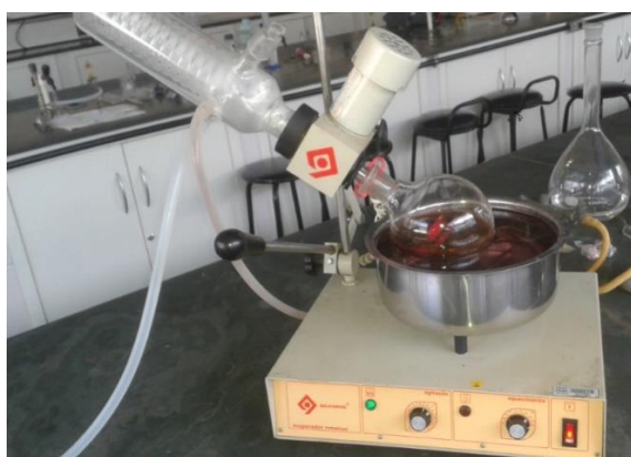
Figura 21. Sistema reacional para polpação Acetosolv da palha de cana.
