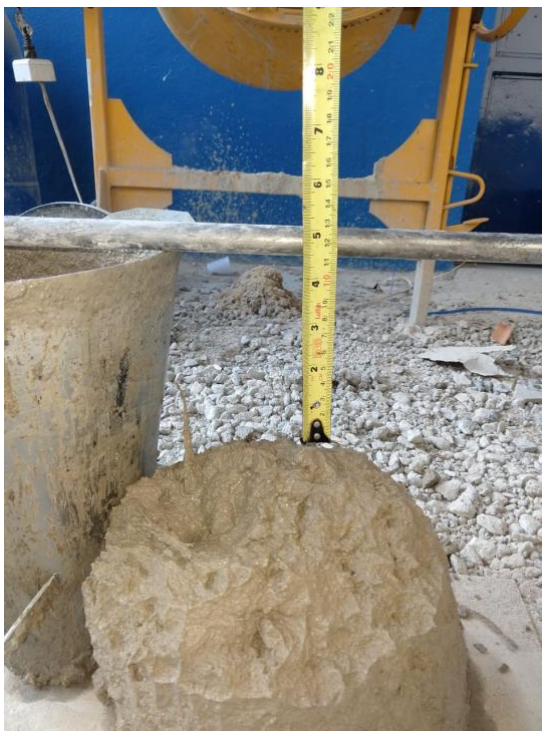
Figura 10. Medição do abatimento através de Slump Test (Fonte: Autoria própria)
