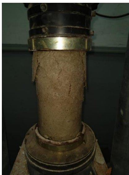
Figura 11. Corpo de prova inserido na prensa hidráulica durante aplicação de carga (Fonte: Autoria própria)
