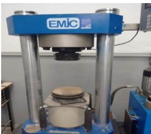
Figura 11. Prensa hidráulica EMIC, utilizada nos ensaios de resistência à compressão axial (Fonte: Autoria própria)
