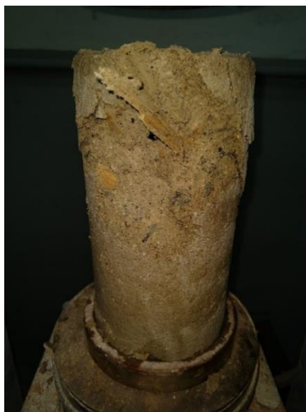
Figura 122. Corpo de prova rompido após ensaio de compressão (Fonte: Autoria própria)
