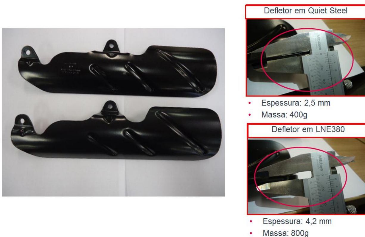
Figura 14 – Comparativo de espessura e massa entre os defletores LNE 380 x Quiet Steel®. [6]
