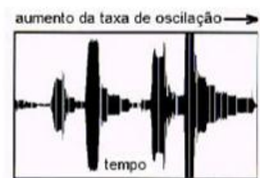
Figura 8 - Placa excitada por força variável. [5]. Figura 9 - Resposta da placa. [5]
