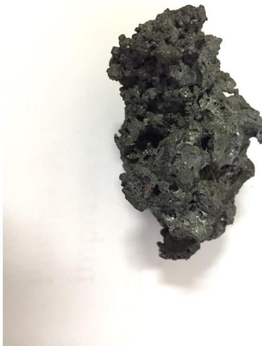
Figura 44-- Amostra de sínter obtida após processamento da mistura 4
