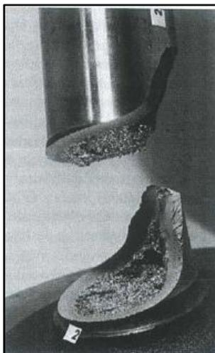
Figura 20: Macrofractografia de um aço SAE 1050 com fratura frágil
