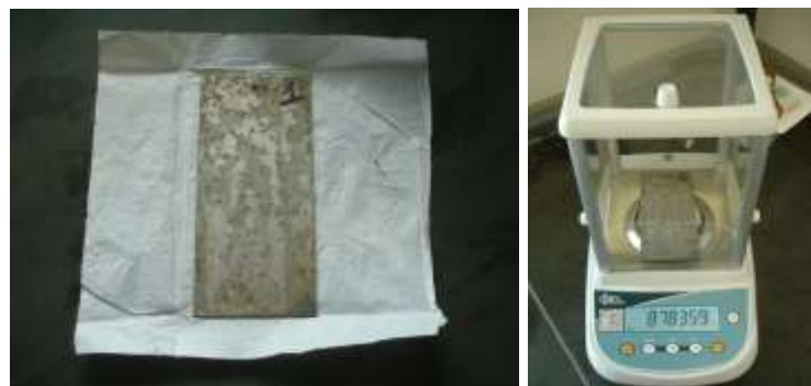
Figura 55 - Verificação da massa final
