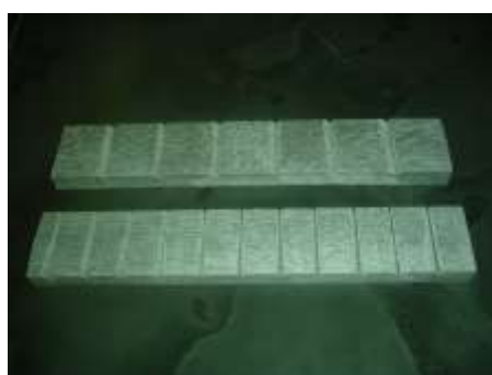
Figura 33 - Suporte porta-amostra com encaixes na angulação de 15° e 30°
