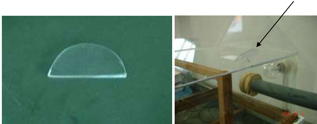
Figura 40 - Puxador fixado na parte móvel da tampa
