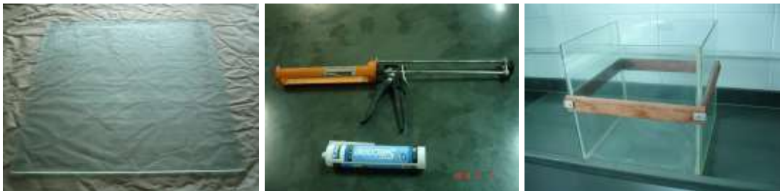
Figura 19 - Montagem da câmara
