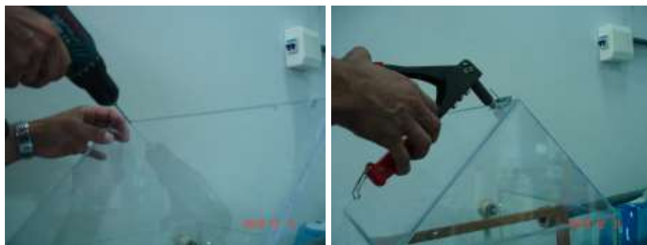
Figura 39 - Fixação das dobradiças na parte fixa da tampa
