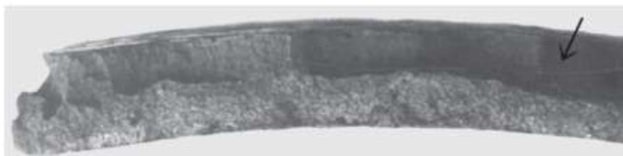
Figura 12 - Corrosão gráfita do ferro fundido cinzento
