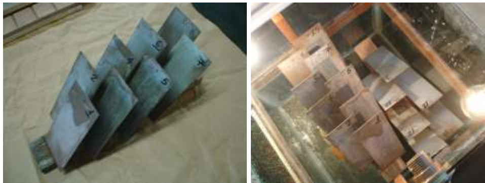
Figura 47 - Disposição dos cp's no interior da câmara
