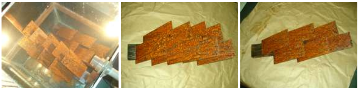
Figura 53 - Cp's do aço extra doce em processo de corrosão
