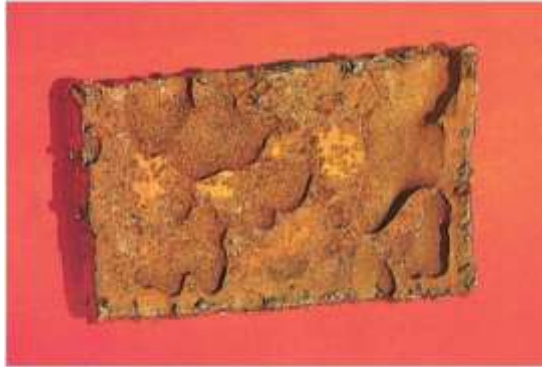
Figura 7 - Corrosão em placas
