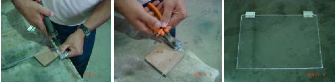
Figura 38 - Fixação das dobradiças
