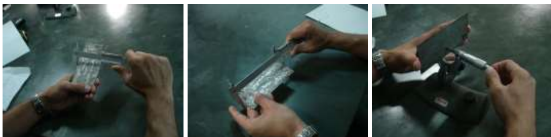
Figura 44 - Medição das dimensões dos cp's
