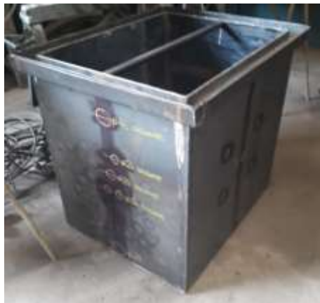
Figura 40. Gabinete em chapa de aço carbono [Fonte: autor]
