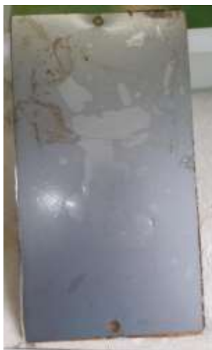
Figura 53. Corpo de prova protegido por uma película [Fonte: autor]
