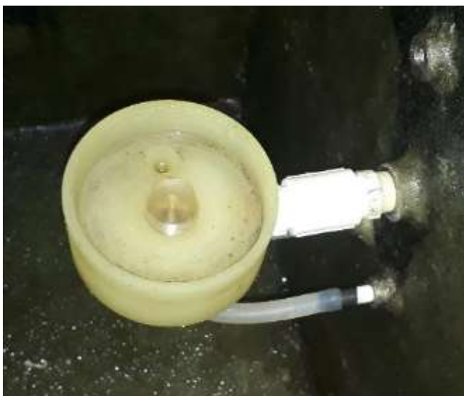
Figura 46. Suporte com bico atomizador [Fonte: autor]
