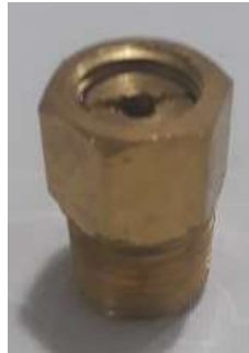
Figura 21. Válvula de segurança do saturador [Fonte: autor]
