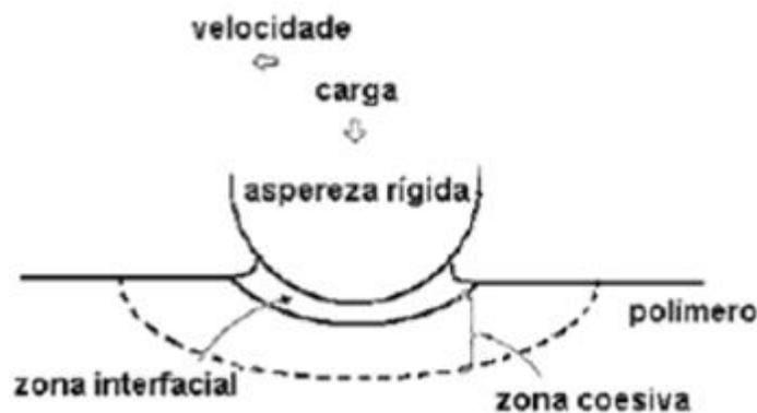
Figura 17: Aspereza dura deslizando sobre superfície polimérica.
