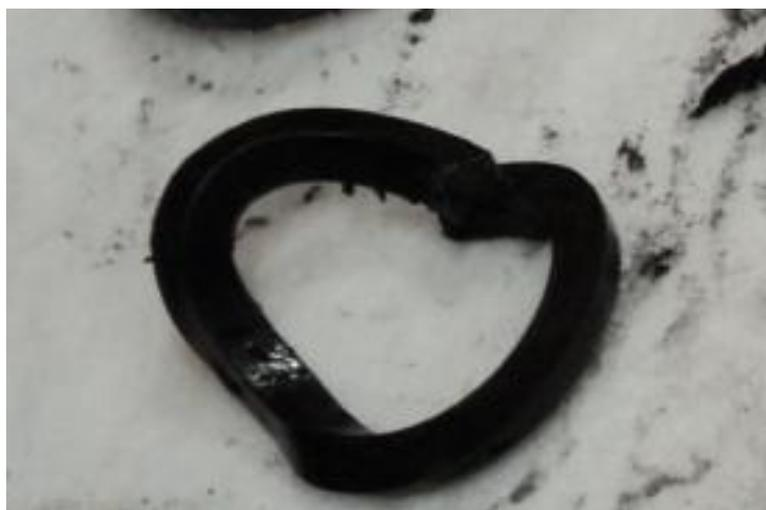
Figura 35: PTFE deformado.
