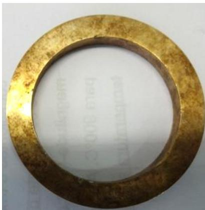
Figura 28: Amostra após ataque com Cloreto Férrico a 5%.
