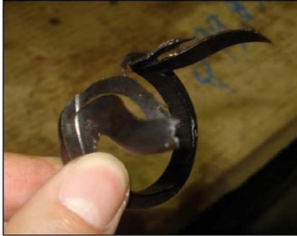
Figura 1: PTFE em falha.
