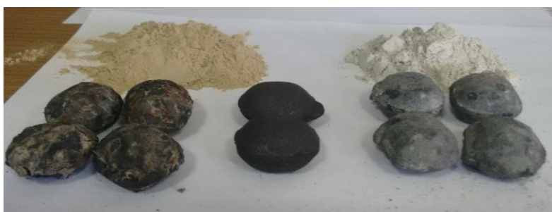
Figura 36. Briquetes com agente de revestimento (Esquerda) Briquetes com revestimento de bentonita (Centro) Briquetes sem revestimento (Direita) Briquetes com revestimento de calcário dolomítico
