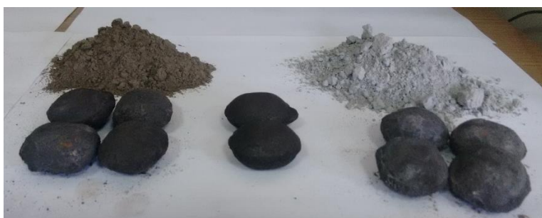
Figura 35. Briquetes com agente de revestimento (Esquerda) Briquetes com revestimento de escória de aciaria (Centro) Briquetes sem revestimento (Direita) Briquetes com revestimento de serpentinito
