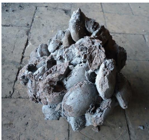
Figura 11. Formação de cachos de briquetes na região B3 da cuba superior do forno Tecored
