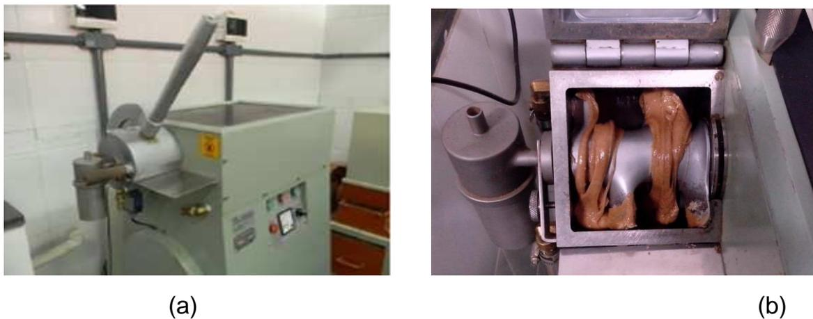
Figura 3.3 Homogeneizador (a); mistura do PEBD e fibras (b); material obtido (c). Fonte: A autora, 2014
