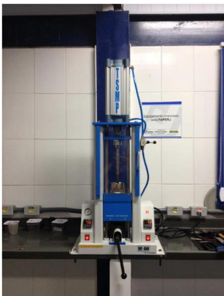
Figura 3.5. Máquina Injetora
