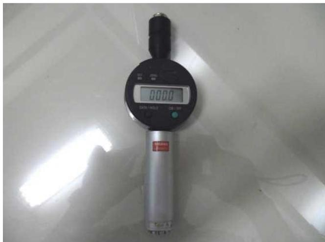
Figura 3.11 Durômetro utilizado no trabalho
