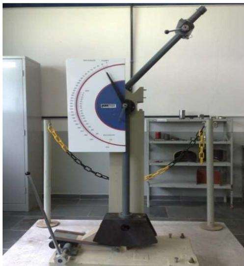
Figura 3.10 Máquina PANTEC para ensaio de impacto Charpy Fonte:
