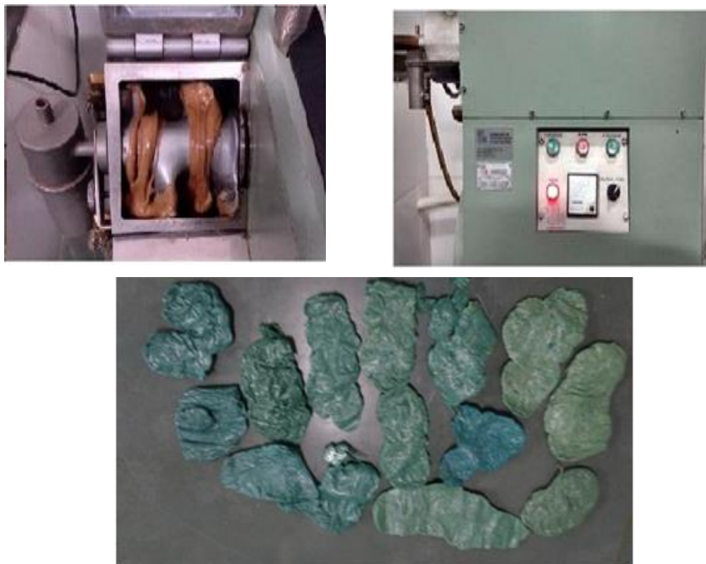
Figura 16. Homogeneizador com a mistura dos compósitos, homogeneizador e plástico após homogeneização
