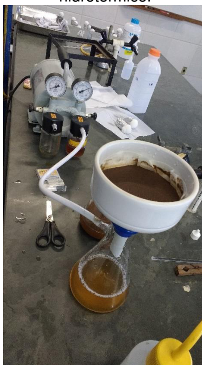
Figura 20. Processo de separação das partes sólida/líquida após tratamento hidrotérmico.
