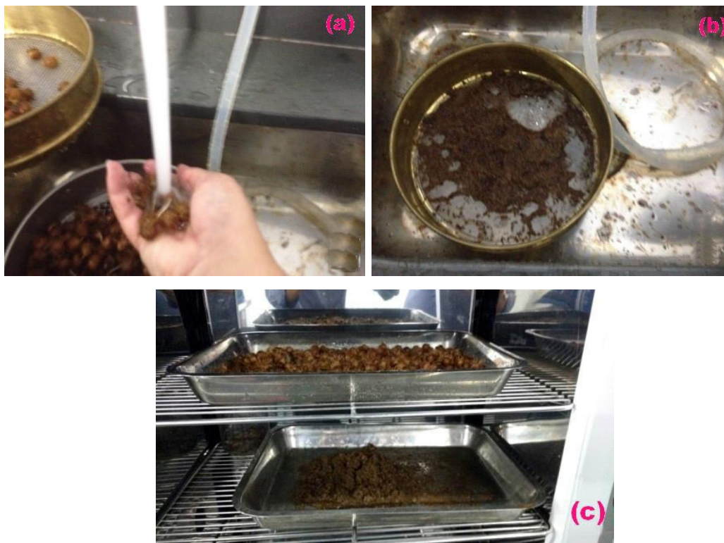
Figura 17. Resíduo de açaí: a) processo de lavagem; b) material passante pela primeira peneira; c) processo de secagem.
