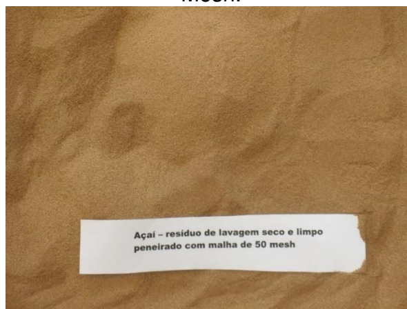
Figura 18. Resíduo de lavagem do açaí peneirado com granulometria inferior a 50 Mesh.
