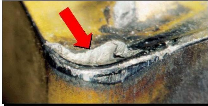
Figura 5 Desgaste de cratera de uma ferramenta de corte
