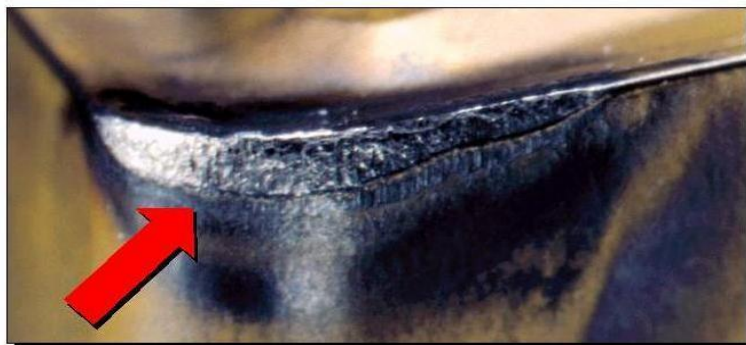
Figura 6 Desgaste de flanco de uma ferramenta de corte
