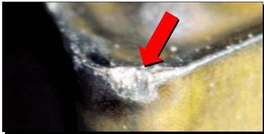
Figura 8 Lascamento de uma ferramenta de corte
