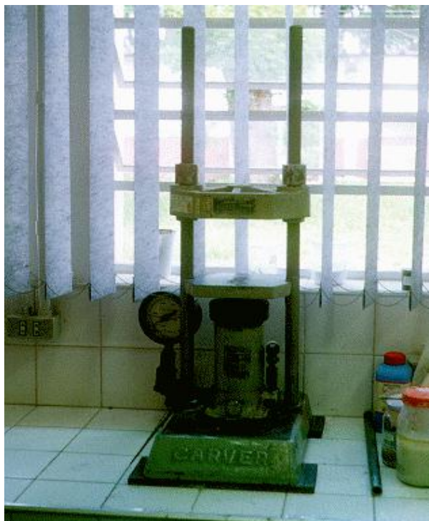
Figura 14 Vista da prensa hidráulica uniaxial utilizada na compactação das pastilhas.
