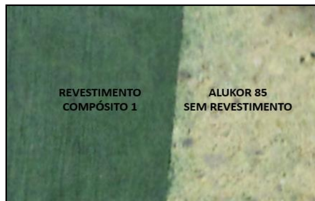
Figura 57 – Camada de revestimento no corpo de prova.
