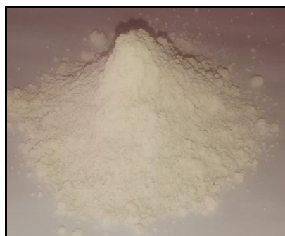
Figura 38 – Óxido de alumínio calcinado (Alumina).
