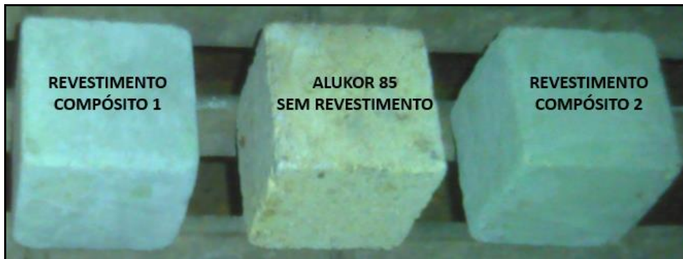
Figura 55 – corpos de provas preparados para testes (Cubos).
