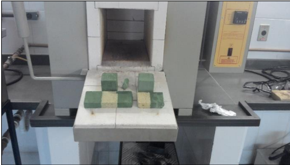
Figura 50 – Corpos de prova no forno antes de aquecer.
