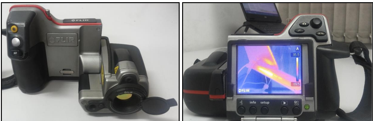
Figura 52 – Máquina termográfica Flir.
