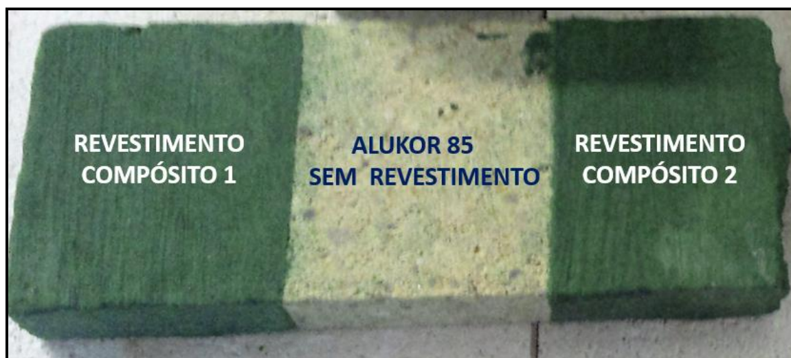
Figura 54 – Corpo de provas preparado para testes (Placa 1).
