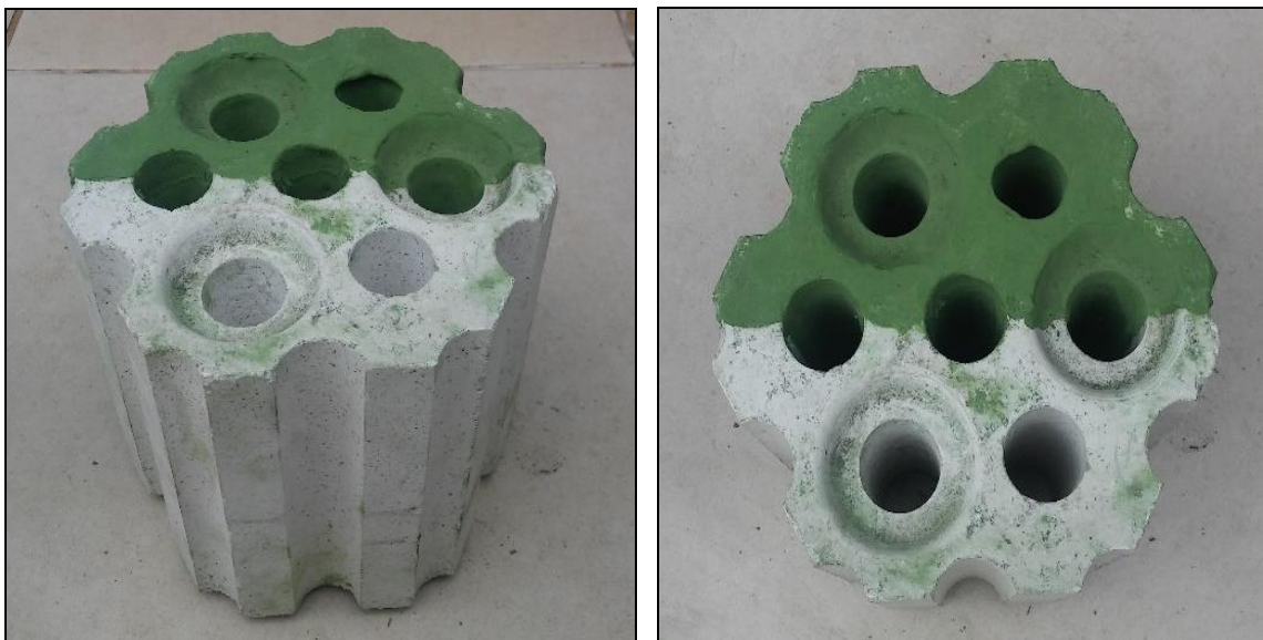
Figura 47 – Peças de checker com 50% de revestimento.
