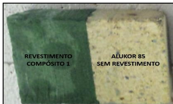
Figura 56 – Corpo de provas preparado para testes (Placa 2).
