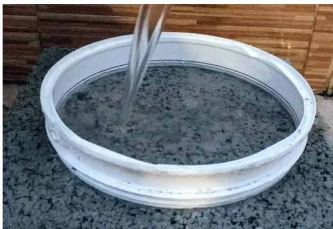
Figura 34: Determinação do coeficiente de permeabilidade
