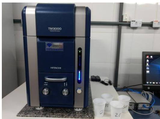
Figura 27: MEV Hitachi modelo TM 3000
