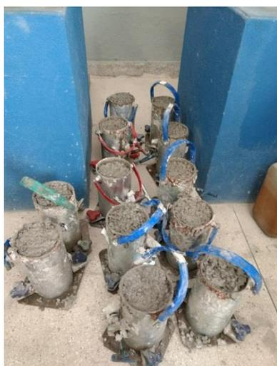
Figura 18: Formas zincadas para CP's cilíndricos
