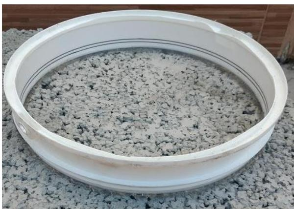
Figura 32: Montagem do ensaio para determinação do coeficiente de permeabilidade (a)
