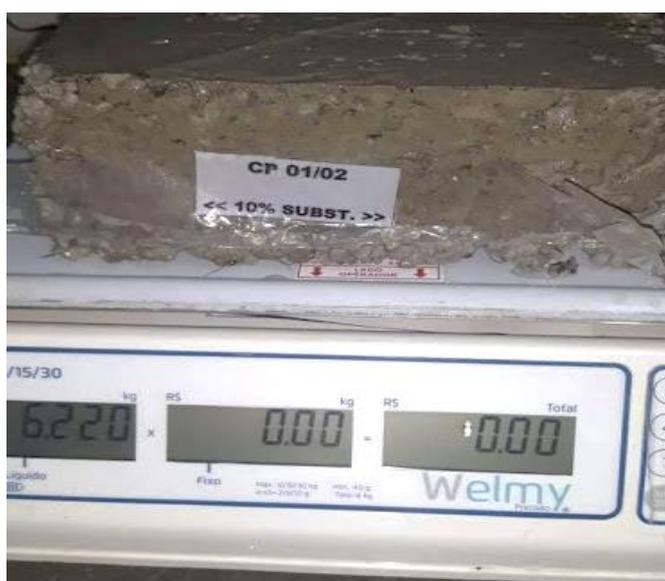
Figura 25: Pesagem do CP saturado por 72h
