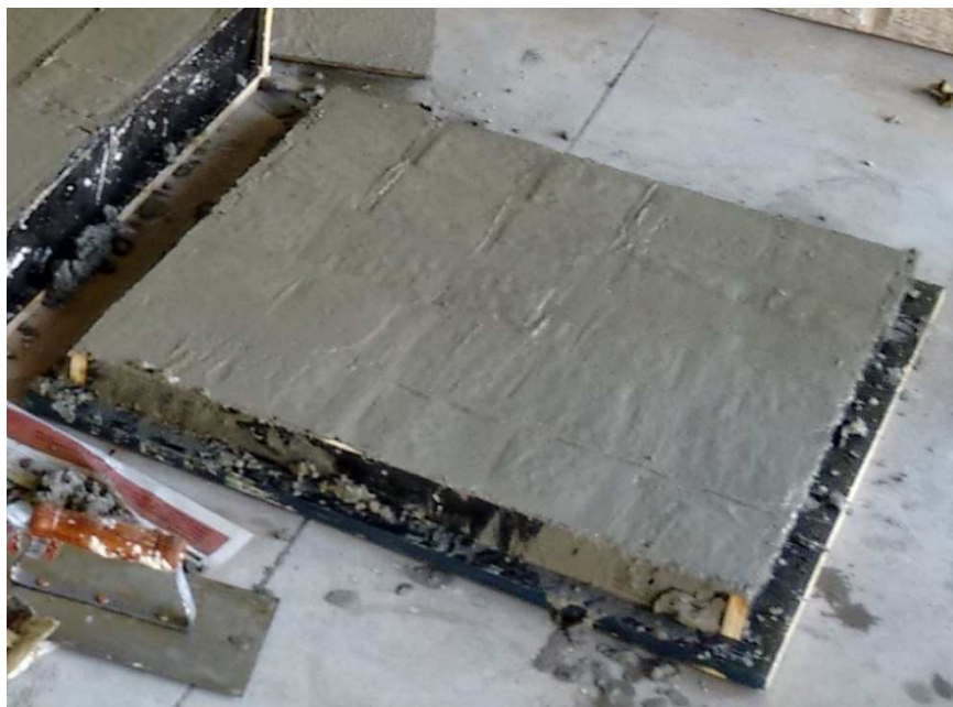
Fotografia 3 - Enchimento dos corpos de prova prismáticos para ensaio de desgaste a abrasão
