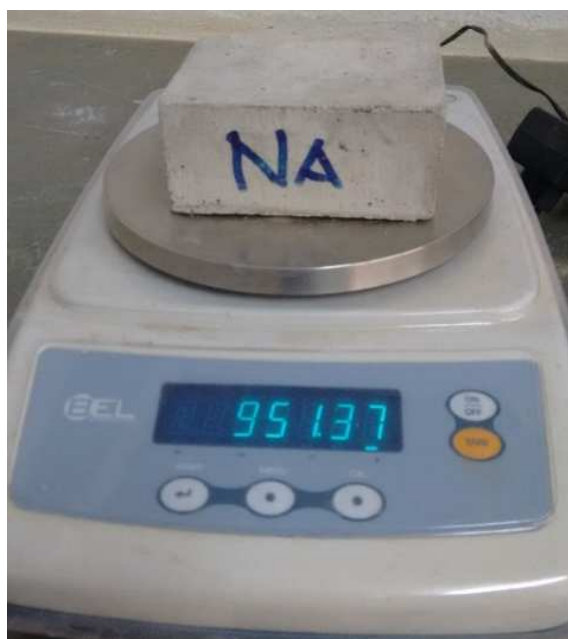
Fotografia 17 - Pesagem das amostras secas
