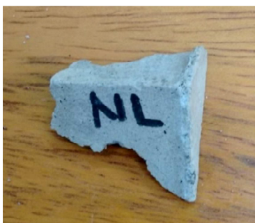
Fotografia 22 - Amostra de CP com Silicato de Sódio/Lítio
