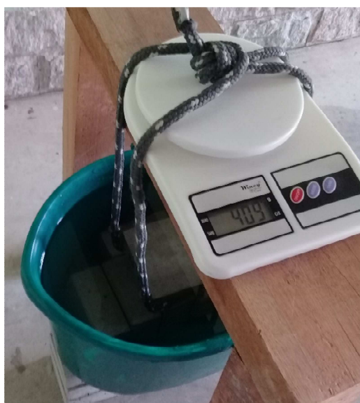
Fotografia 18 - Pesagem da amostra imersa em água
