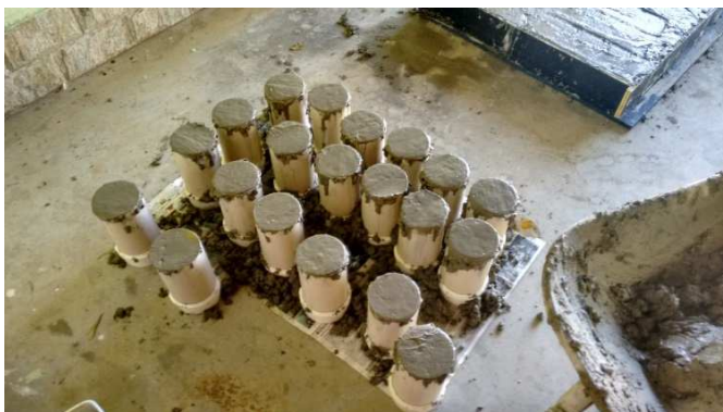
Fotografia 1 - Enchimento dos corpos de prova cilíndricos
