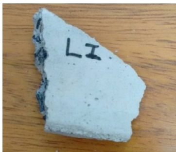
Fotografia 20 - Amostra de CP com Silicato de Lítio
