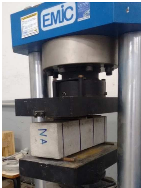
Fotografia 10 - Corpo de prova com aplicação de silicato de sódio
