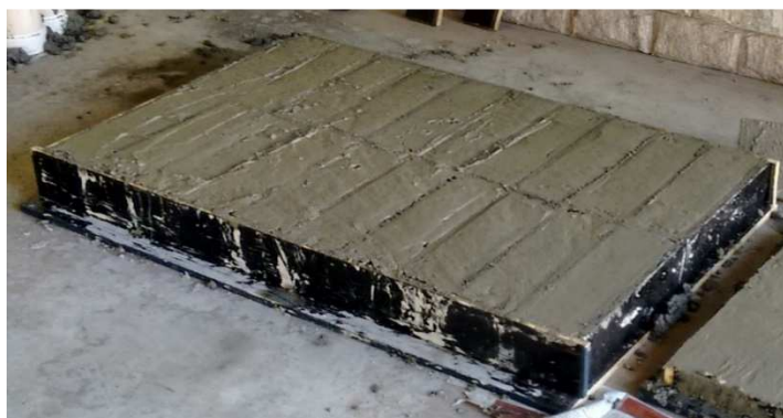
Fotografia 2 - Enchimento dos corpos de prova prismáticos
