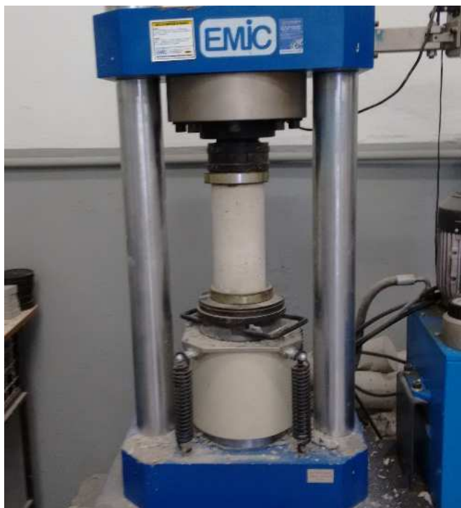
Fotografia 8 - Corpo de prova sem aplicação para controle
