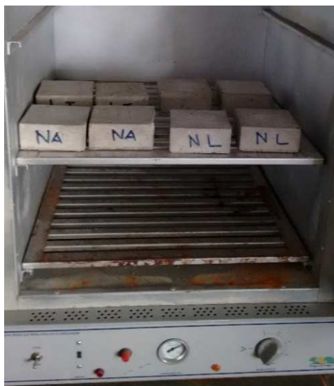
Fotografia 16 - Secagem das amostras na estufa
