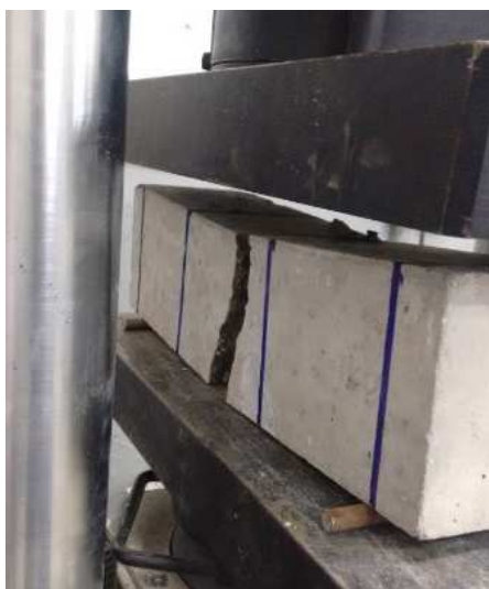
Fotografia 12 - Corpo de prova rompido no terço médio
