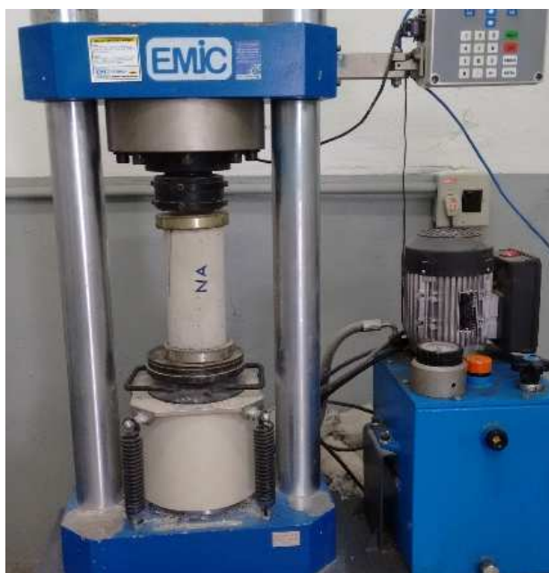
Fotografia 5 - Corpo de prova com aplicação de silicato de sódio
