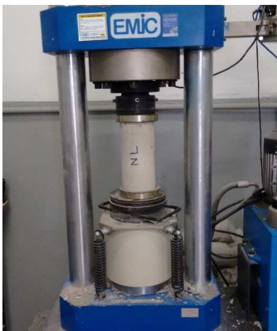
Fotografia 7 - Corpo de prova com aplicação de silicato de sódio/lítio
