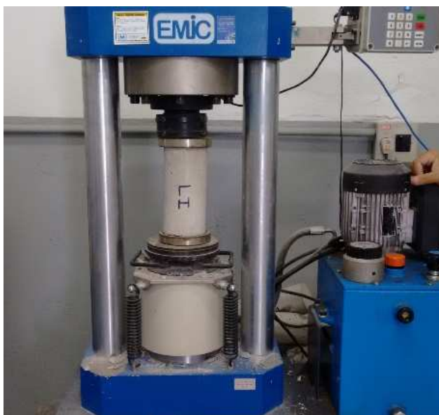
Fotografia 6 - Corpo de prova com aplicação de silicato de lítio
