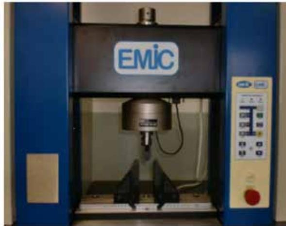
Figura 3.8. Dispositivo usado para o ensaio de flexão.
