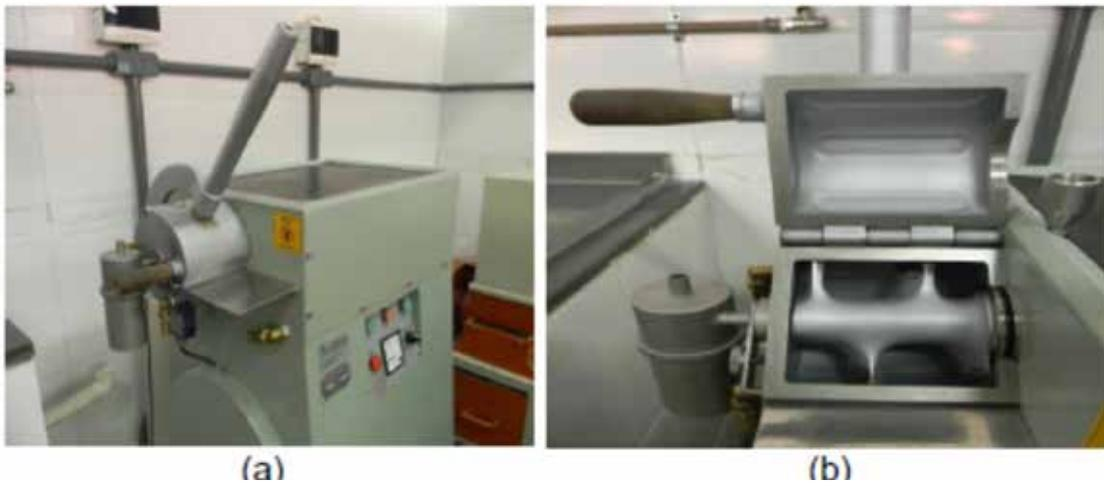
Figura 3.3. Homogeneizador (a) e detalhe da cápsula de mistura (b).
