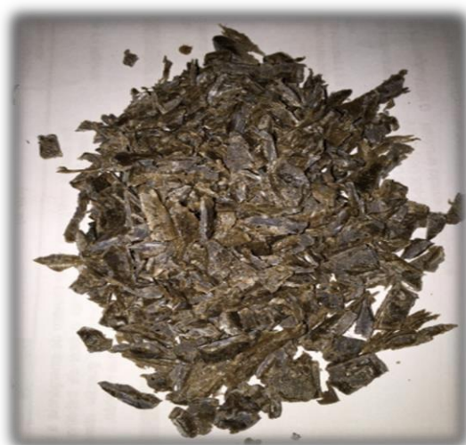
Figura 8 - Compósito homogeneizado e triturado
