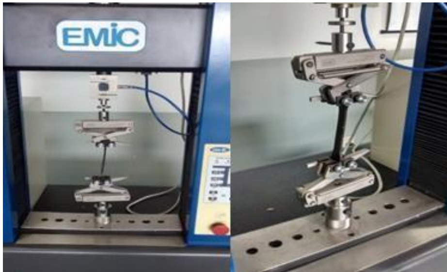
Figura 11 – Equipamento EMIC DL 10000 – Ensaio de Tração
