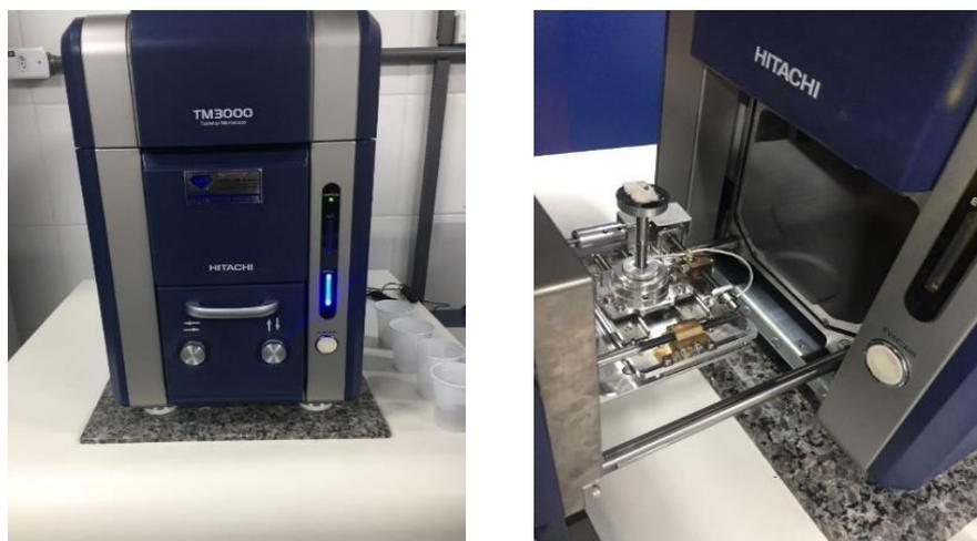
Figura 15 - MEV Hitachi modelo TM 3000
