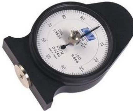
Figura 9 - Durômetro portátil, marca CV Instrument Limited, modelo CV Shore Durometers – Analogue.
