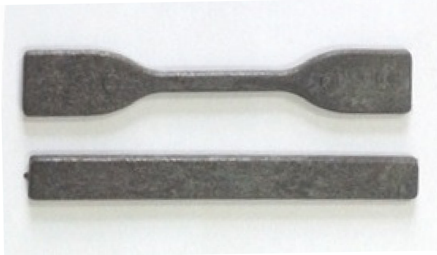
Figura 37 - Corpos de provas dos compósitos obtidos para os ensaios de tração e flexão.
