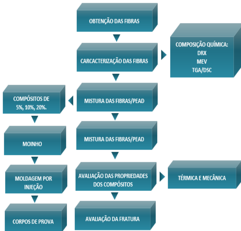
Figura 18 - Fluxograma de processamento e caracterização do compósito.
