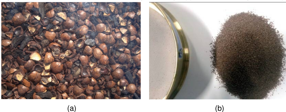
Figura 25 – Fibras da casca de noz macadâmia após a extração (a) Fibras trituradas e peneiradas (b).
