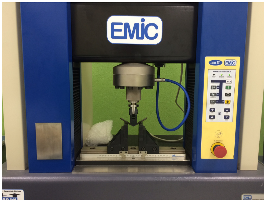
Figura 24 - Dispositivo usado para o ensaio de flexão.
