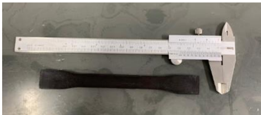
Figura 6. Corpo de prova para o ensaio de tração com 10% de PAE e 10% de HIPS.
