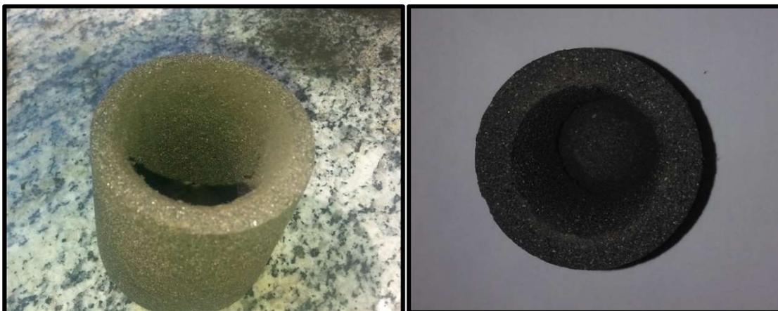
Após confecção e montagem, além da inspeção visual para detecção de possíveis defeitos superficiais, foram realizadas inspeções dimensionais, como mostra a figura 51, que têm como objetivo básico, avaliar o encaixe da luva no molde durante a montagem, na produção.
