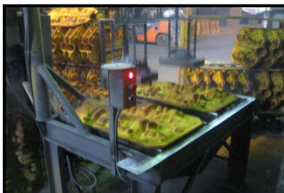
Esta operação é necessária para garantir um bom nível de planicidade das cascas e conseqüentemente um bom fechamento, desta forma, reduzindo a possibilidade de formação de rebarbas na linha de separação [30,21].
