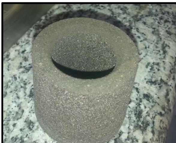
O tampo, confeccionado com a mistura para luvas exotérmicas, foi moldado em um protótipo de molde, construído em polímero e compactado à mão, conforme apresentado na figura 37.
