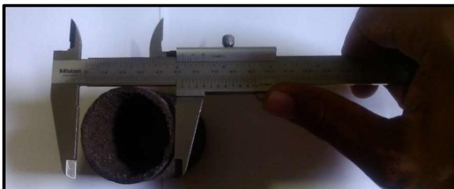
Os resultados da inspeção apontam para uma estabilidade dimensional das luvas, onde todas as dimensões encontradas estavam dentro das tolerâncias especificadas, conforme apresentadas na figura 52.
