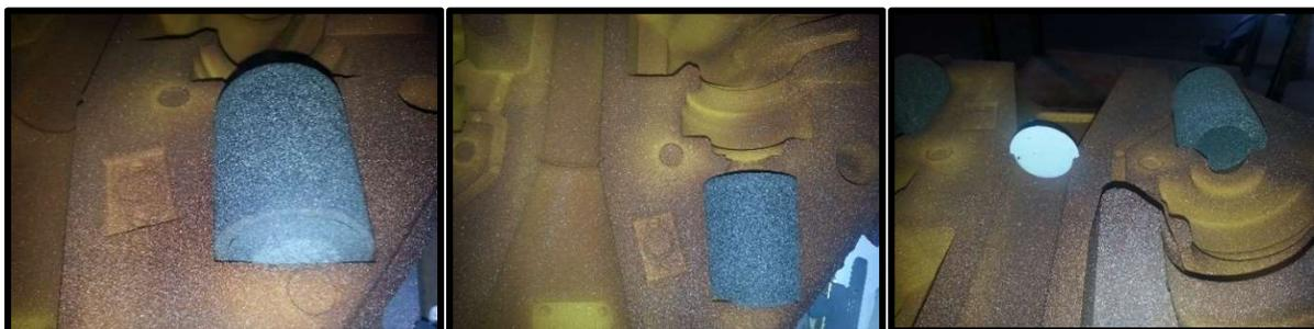
Após a preparação dos moldes e moldagem, as amostras foram vazadas e seguiram para as linhas de resfriamento, quebra dos canais e dos massalotes, jateamento com granalhas de aço, acabamento final e inspeção, local onde as amostras foram separadas das demais peças e enviadas aos respectivos laboratórios para realização dos testes específicos, cujos resultados representam as condições específicas e os efeitos da utilização da nova luva.
