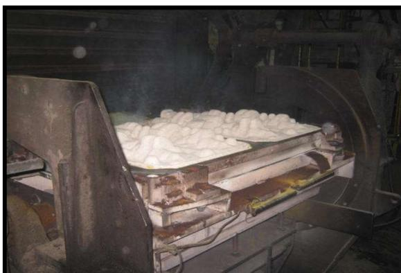
Para que as cascas estejam preparadas para a etapa posterior é necessário realizar a cura completa das mesmas, visto que a parte que não teve contato direto com a placa aquecida necessita de temperatura para completar o processo de cura. Esta etapa é realizada com uma fonte calor sobre a casca através de um forno ou estufa, com temperaturas entre 280° a 350° (figura 20) [30,21].
