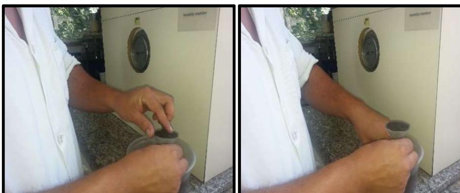
Finalizadas estas operações e, com os corpos e tampos preparados nas dimensões e materiais propostos, os mesmos foram então enviados e tratados na estufa, com uma temperatura controlada ( $100\pm 5^{\circ}\text{C}$  durante 80 minutos) pois apresentavam teores residuais de umidade e para completarem a cura das misturas, conforme mostrado na figura 38.
