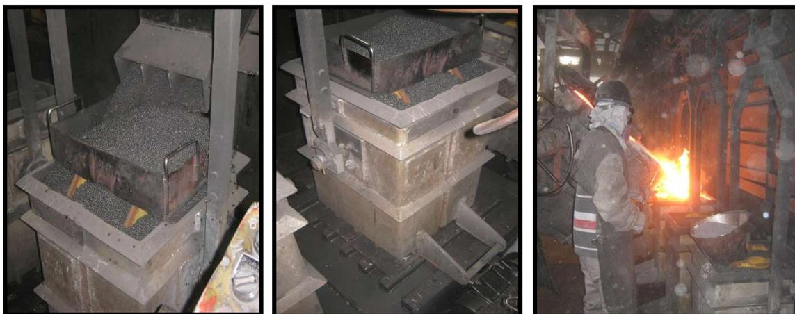
Na figura 25 é demonstrado que após o vazamento das peças, estas seguem resfriando até chegarem à estação de desmoldagem, local onde as peças são extraídas das caixas de moldagem, as granalhas retornam para o processo e os resíduos de cascas e insumos são retirados do sistema [21].
