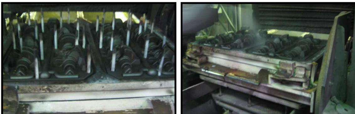
Os ferramentais utilizados neste processo (modelos, placas), são confeccionados em metal ou ligas metálicas, aço e/ou ferro fundido. São compostos de placa base, modelos, sistemas de alimentação e enchimento, pinos extratores e placa extratora.
