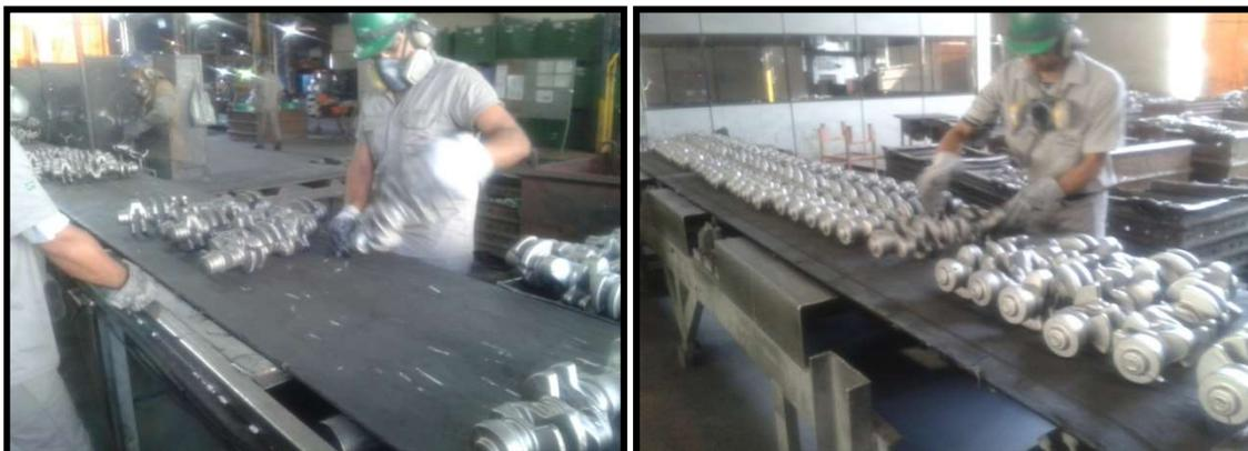
Figura 29. Tanque de oleagem e estação de embalagem das peças
