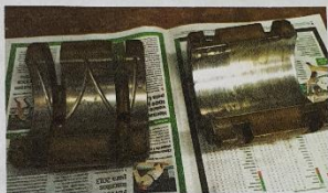
Figura 1 - Mancal danificado retirado de bordo, já limpo aguardando a retirada do metal patente.
