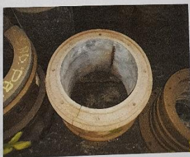
Figura 2 - Mancais limpos, após a retirada do metal patente, prontos para enchimento.
