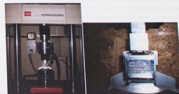
Figura 8: Máquina Universal de Ensaios com adaptador para Flexão – USP-EEL, Demar. A direita fotografia do kit para ensaios de flexão/fatiga.
