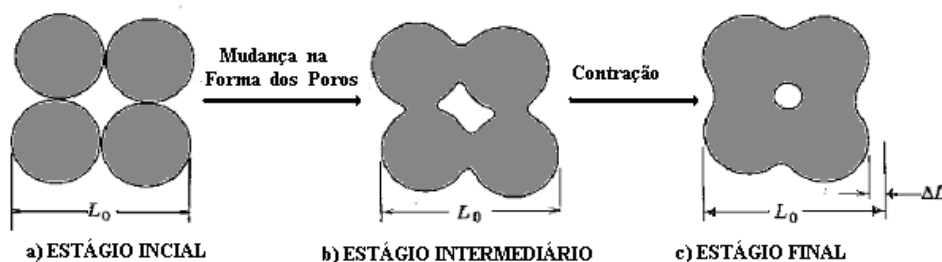
Figura 9 - Variação da porosidade e conseqüente retração, durante o processo de sinterização no estado sólido
