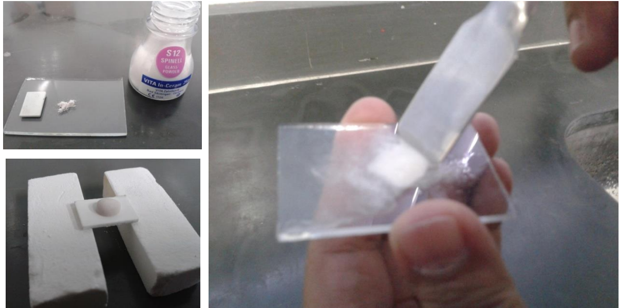
Figura14 - Detalhe da aplicação do vidro na superfície da estrutura cerâmica pré-sinterizada (antes da infiltração).
