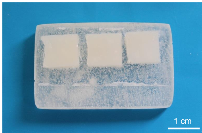
Figura 3.1- Amostras embutida em resina acrílica para o ensaio de cisalhamento
