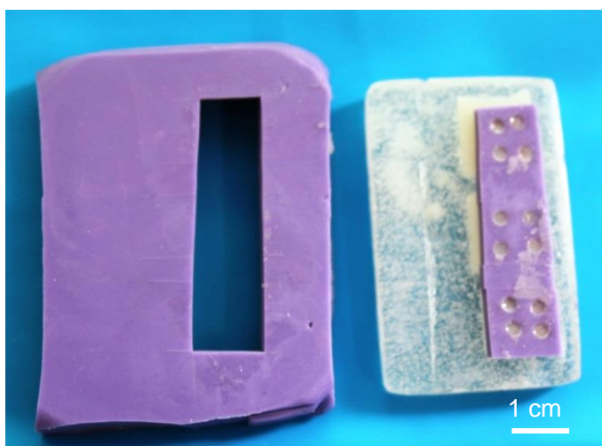
Figura 3.7- Recorte do molde após fotopolimerização do cimento resinoso, para exposição dos pinos de resina.
