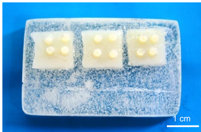
Figura 3.8- Amostras preparadas para o ensaio de cisalhamento.
