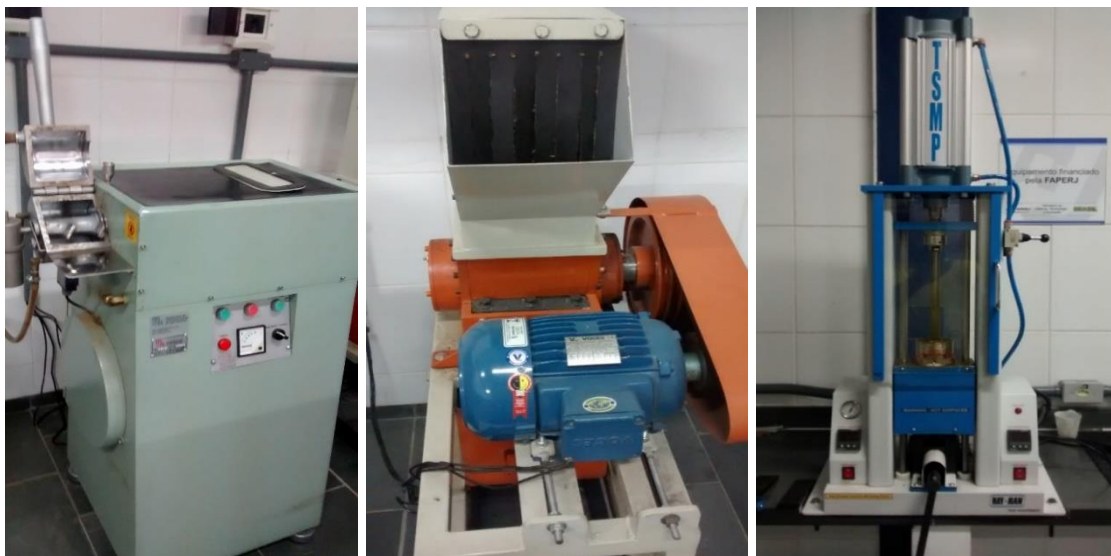
FIGURAS 15a, 15b e 15c – Homogeneizador DRYSLER, Moinho granulador e Injetora RAY-RAM
