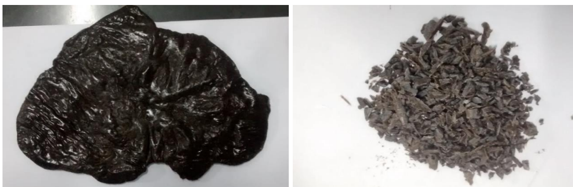
FIGURAS 16a e 16b – Compósitos obtido após homogeneizador e moinho granulador
