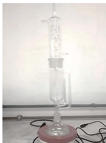
FIGURA 13 – Aparato SOXHLET de extração
