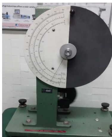
FIGURA 23 – Máquina de ensaios de impacto marca Wolfgang Ohst Rathenow
