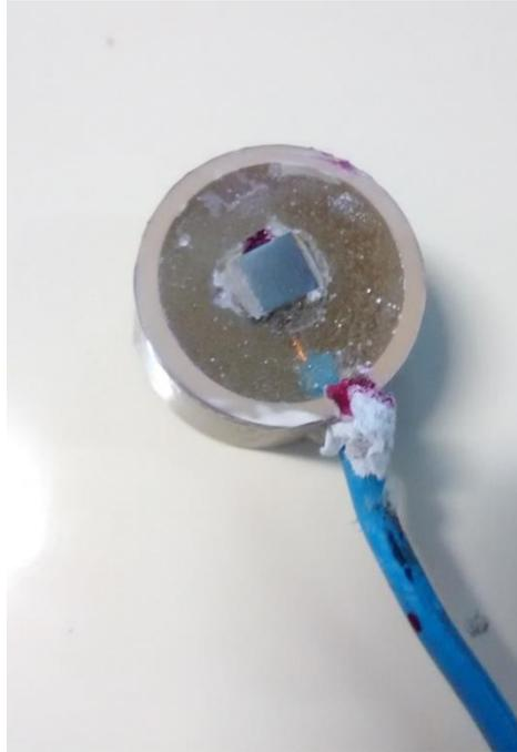
Para realização do ensaio, foi utilizado uma solução com 3,5% de NaCl, concebida a partir de graus químicos analíticos e água destilada, que serviu de eletrólito, além de uma célula convencional contendo três eletrodos: uma grade de platina usada como contraeletrodo e Ag/AgCl saturado como eletrodo de referência. Os parâmetros de potencial desenvolvidos nessa caracterização sempre se opõe a essa referência.
