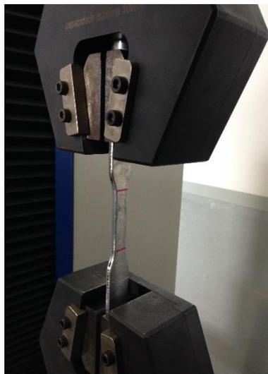
Figura 26. Corpo de prova sendo ensaiado. Fonte: autor.
