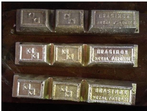
Figura 21. Lingotes do metal patente novo. Fonte: autor.
