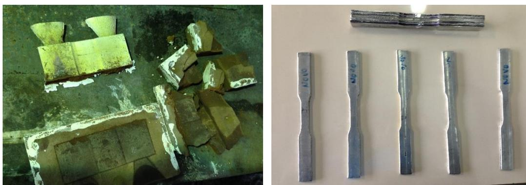
Figura 25. Corpo de prova bruto desmoldado (a) e Corpo de prova finalizado (b).
