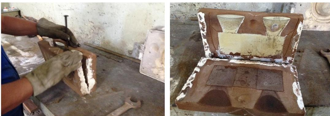
Figura 24. Abertura do molde (a) e Molde aberto (b). Fonte: autor.
