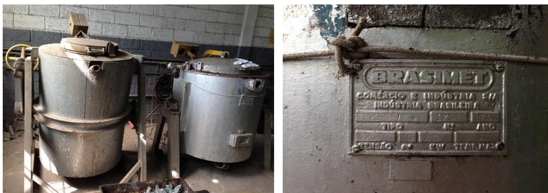
Figura 22. Fornos elétricos para fundição (a) e Detalhe dos fornos (b). Fonte: autor.
