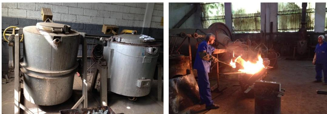
Figura 13. Fornos elétricos para fundição (a) e Maçarico de panela a óleo (b). Fonte: autor.
