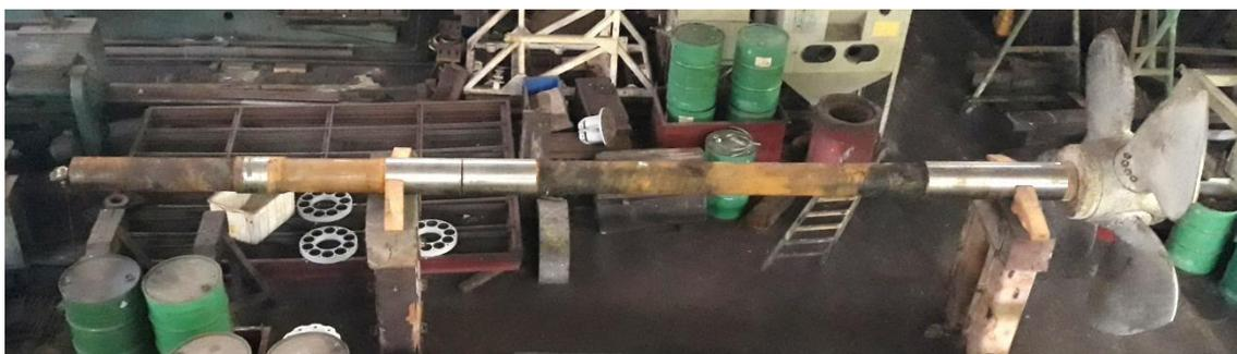
Figura 12. Seção de linha de eixo do navio Almirante Maximiano. Fonte: autor.
