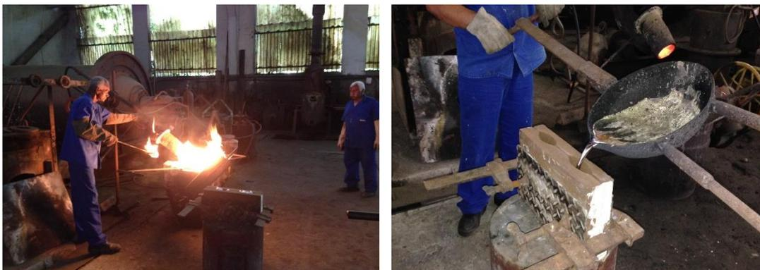
Figura 23. Fundindo metal patente (a) e Vertendo o metal líquido no molde (b).
