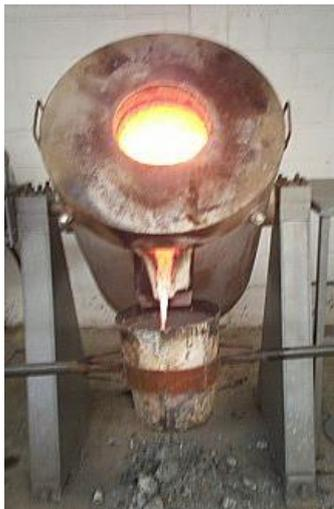
Figura 44. Forno com orifício abaixo da borda. Fonte: [45]
