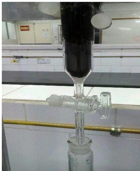
Figura 15. Ensaio preliminares de Adsorção - Alíquotas coletadas após percolação da solução de fenol em filtro de carvão
