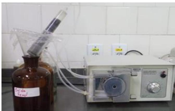
Figura 14. Ensaio de adsorção do filtro à base de carvão com auxílio de bomba peristáltica
