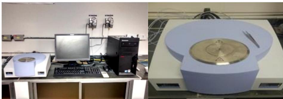
Figura 17. Termobalança Perkin Elmer modelo STA-6000
