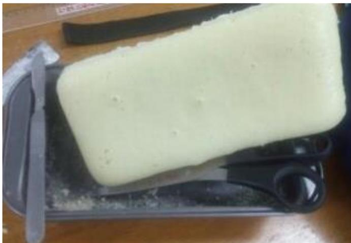
Figura 8. Resina de Poliuretano desenformada após 24h
