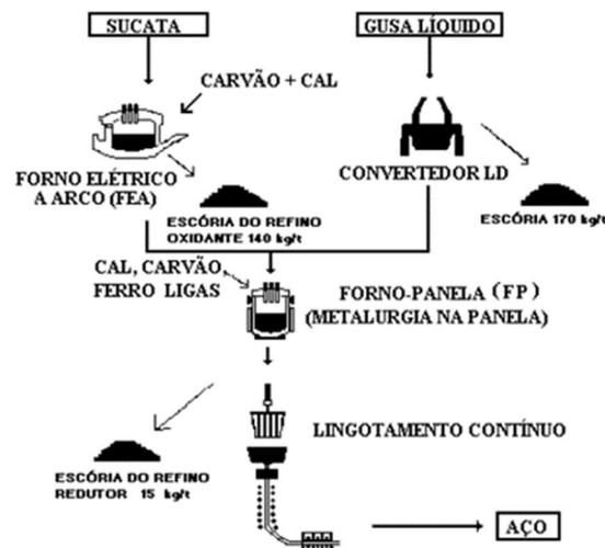
Figura 1: Esquema simplificado da geração de escórias na aciaria elétrica à oxigênio (LD).
