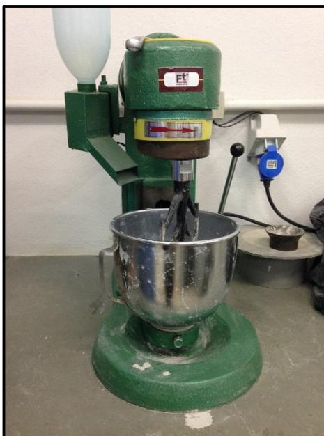
Figura 9: Misturador mecânico de argamassa
