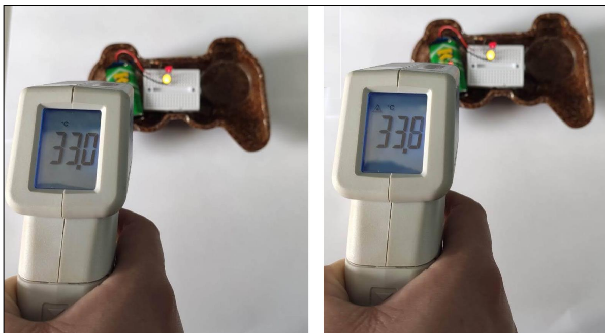
Figura 82 – Temperatura da bateria no manete
