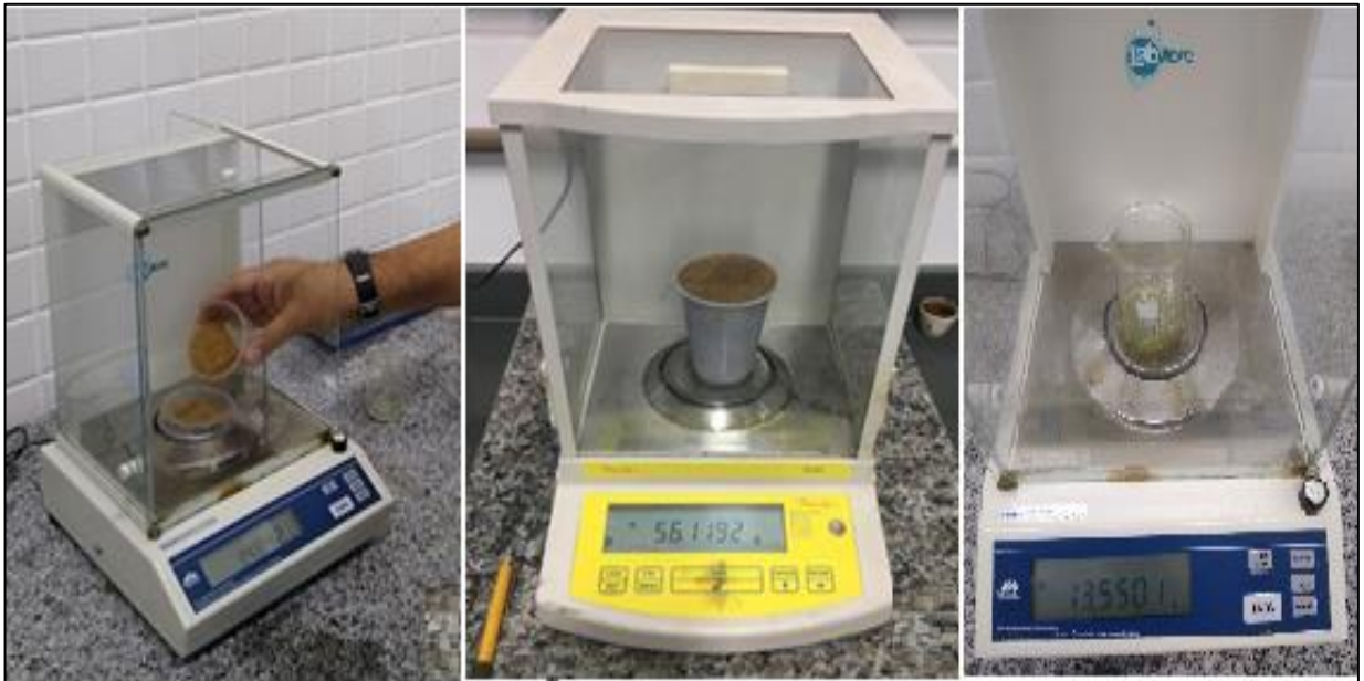
Figura 42 – Preparação e Pesagem do material
