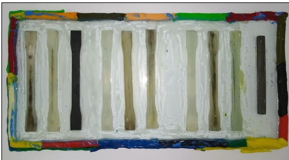
Figura 37 – Preparação dos moldes
