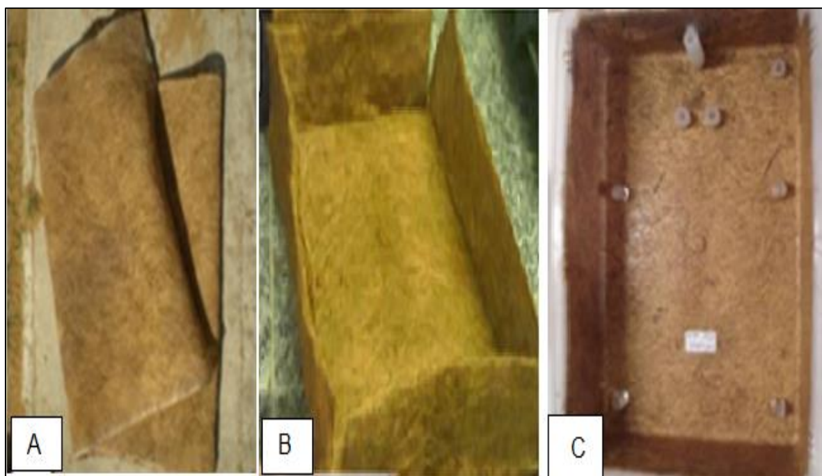
Figura 17 – Compósitos de fibra manta na forma de caixa. A) matéria prima; B) manta em forma de caixa; C) Caixa compactada
