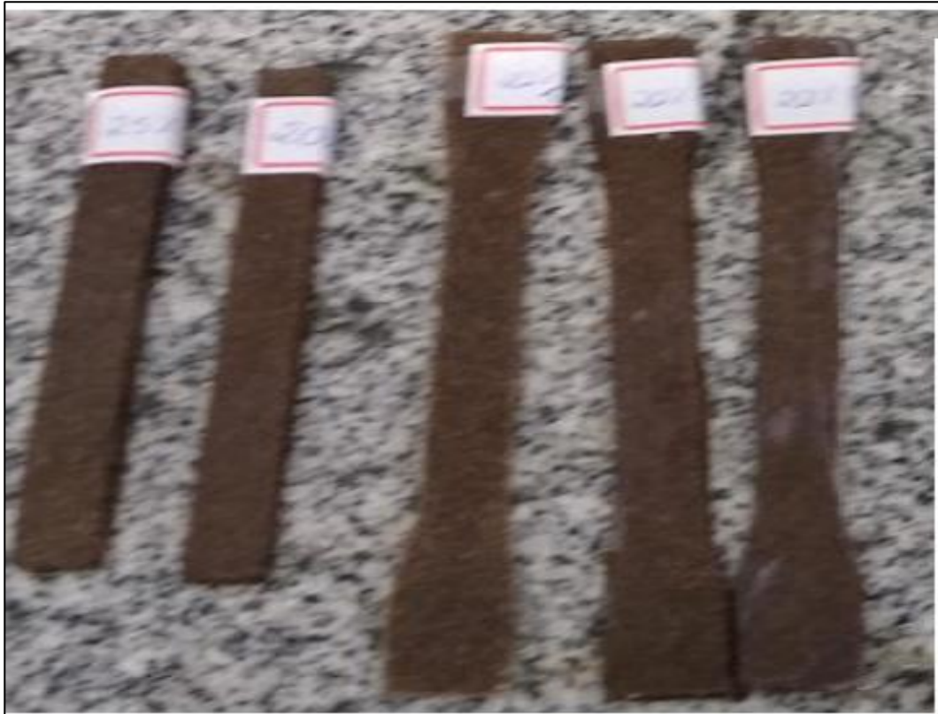
Figura 45 – Cp's desmoldados após período de cura
