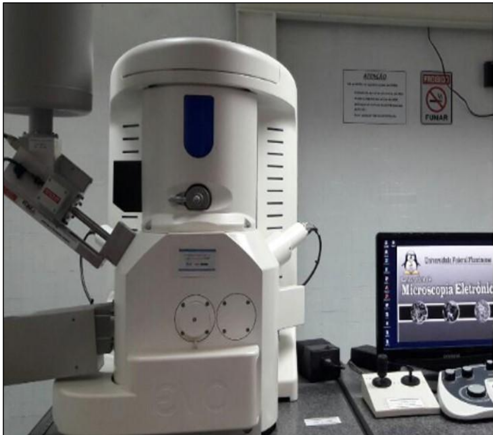
Figura 53 – Microscópio Eletrônico de Varredura (MEV - ZEISS EVO-10)
