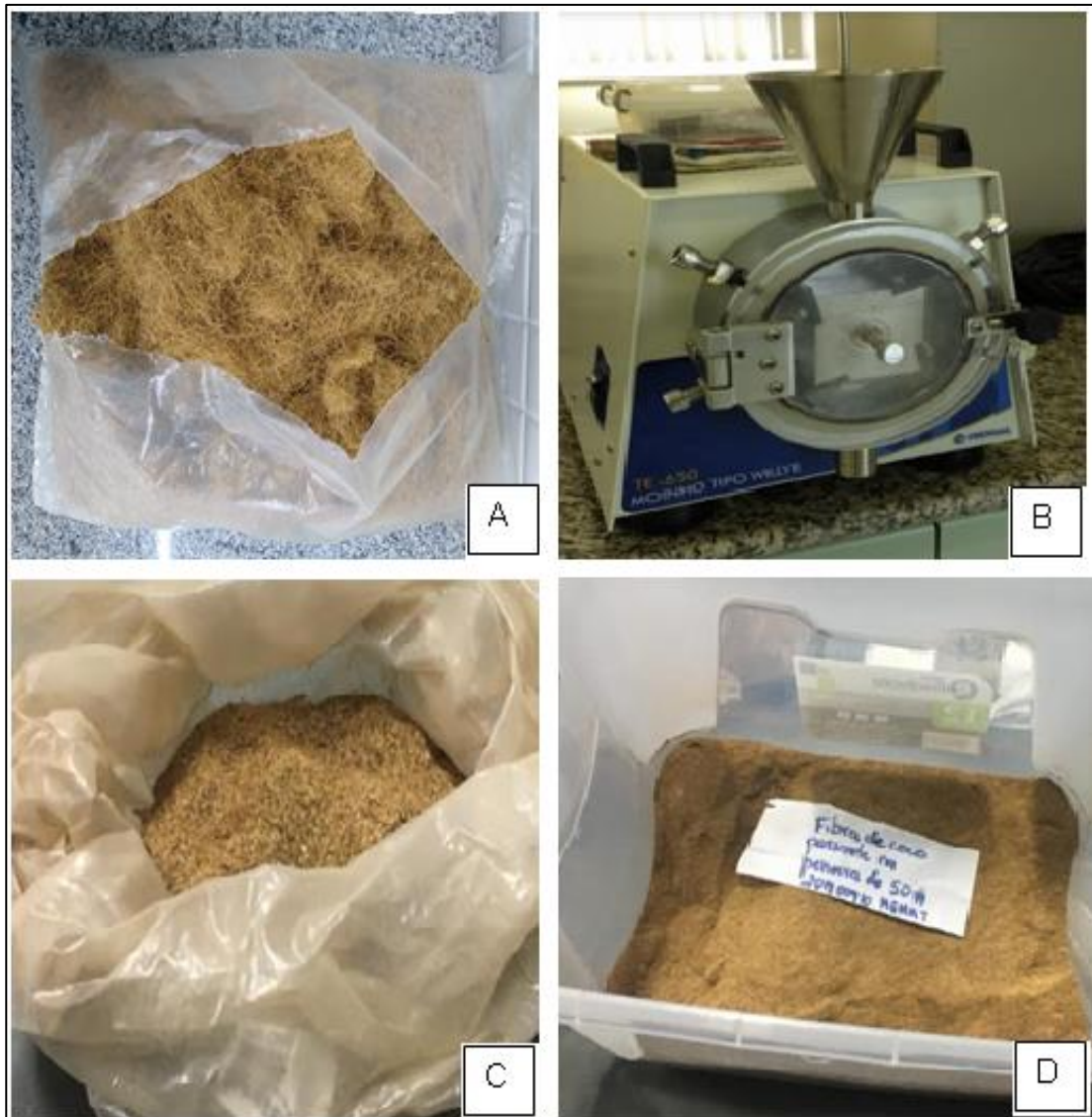
Figura 36 – A) Fibra de coco longa; B) Moinho de polímeros; C) Fibras de coco triturada; D) Fibra de coco peneirada
