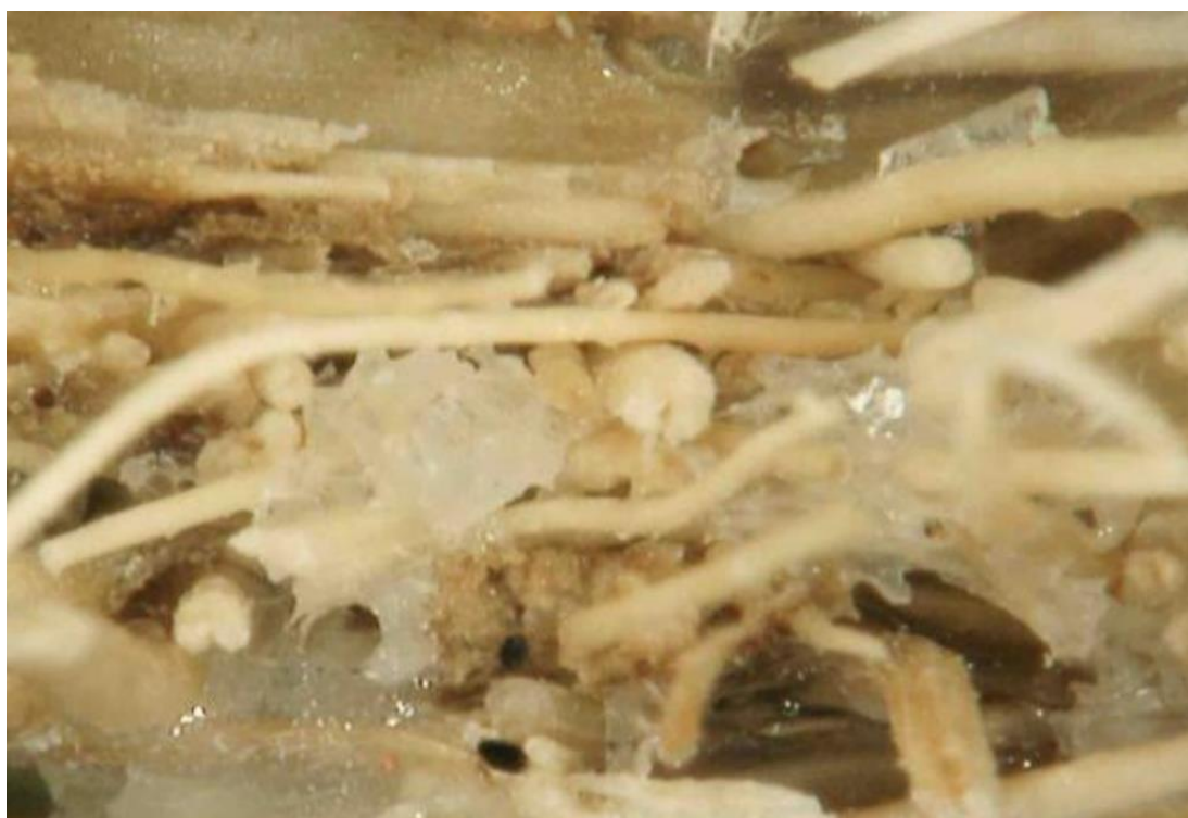
Figura 33 – Imagem da fibra de coco com poliéster
