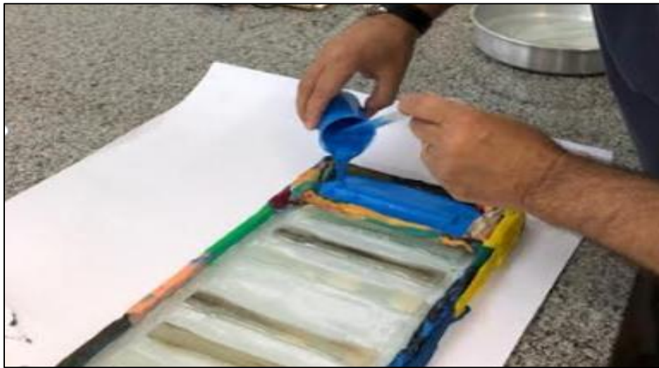
Figura 38 – Preparação do molde borracha de silicone
