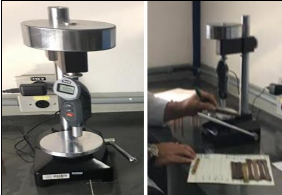
Figura 48 – Aparelho Durômetro modelo TH210 e ensaio de dureza
