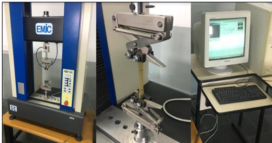
Figura 49 – Máquina de Ensaio EMIC DL-10.000 100 KN
